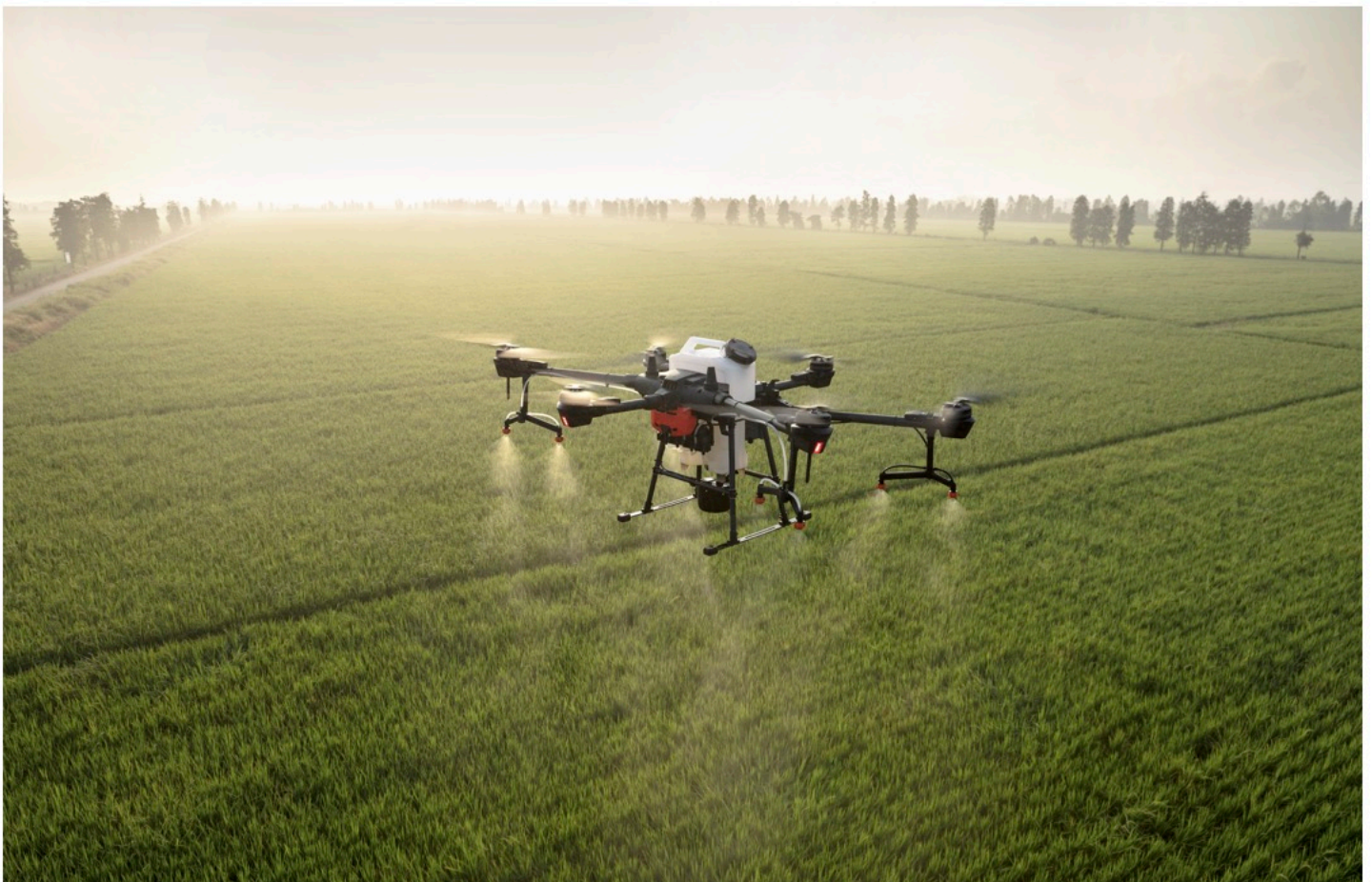
Figura 1.1: Applicazione dei droni nell'agricoltura di precisione, droni per l'irrigazione In questa figura si può osservare un drone DJI modello MG-1P, dotato di serbatoio, utilizzato per l'irrigazione dei campi attraverso avanzate tecniche di "spraying". [8]
