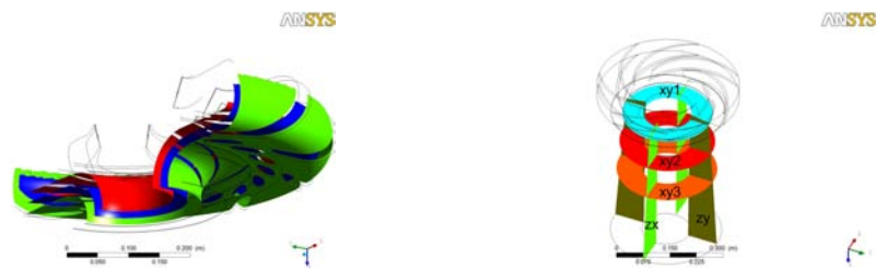
(a) Piani tracciati nel dominio fluido occupato dalla girante e dal distributore
