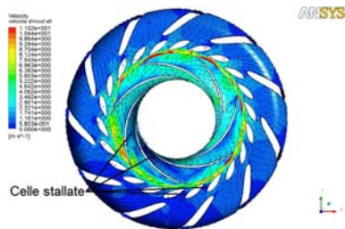
(c) Velocità in prossimità della corona esterna
