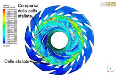
(a) Velocità in prossimità del mozzo
