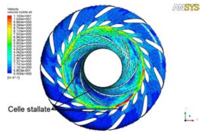
(b) Velocità nel piano mediano
