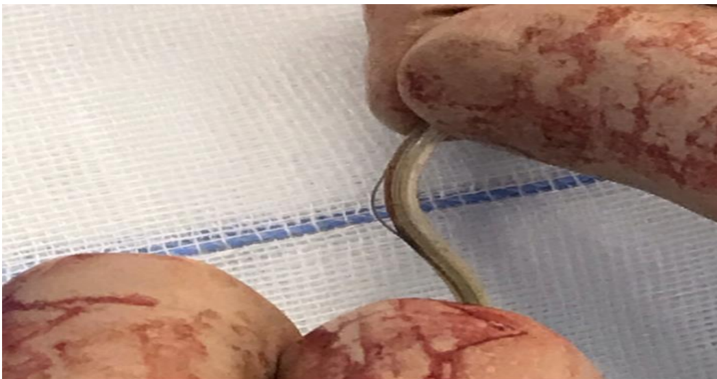
Figura 4. Breccia nella guaina dell'elettrocatteter che interferisce con la ricezione del segnale e causa shock inappropriati.
