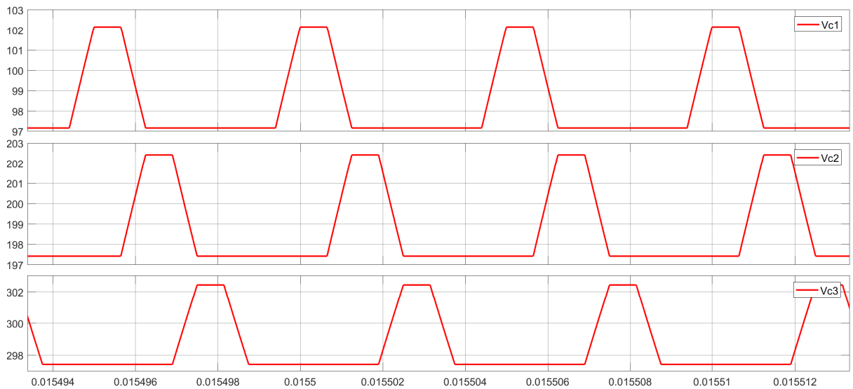
Figura 3.4: Tensioni condensatori flottanti
