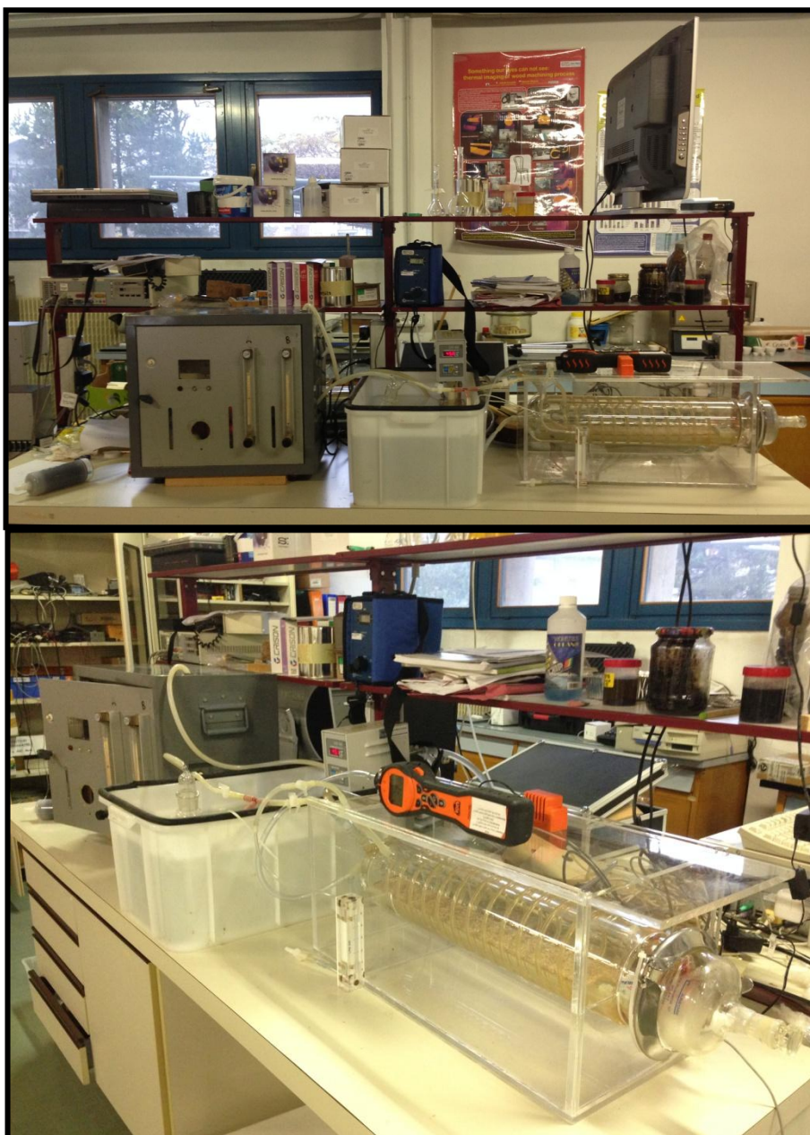
Figura 27: sistema di campionamento TVOC e formaldeide a condizioni di temperatura e umidità variabili
