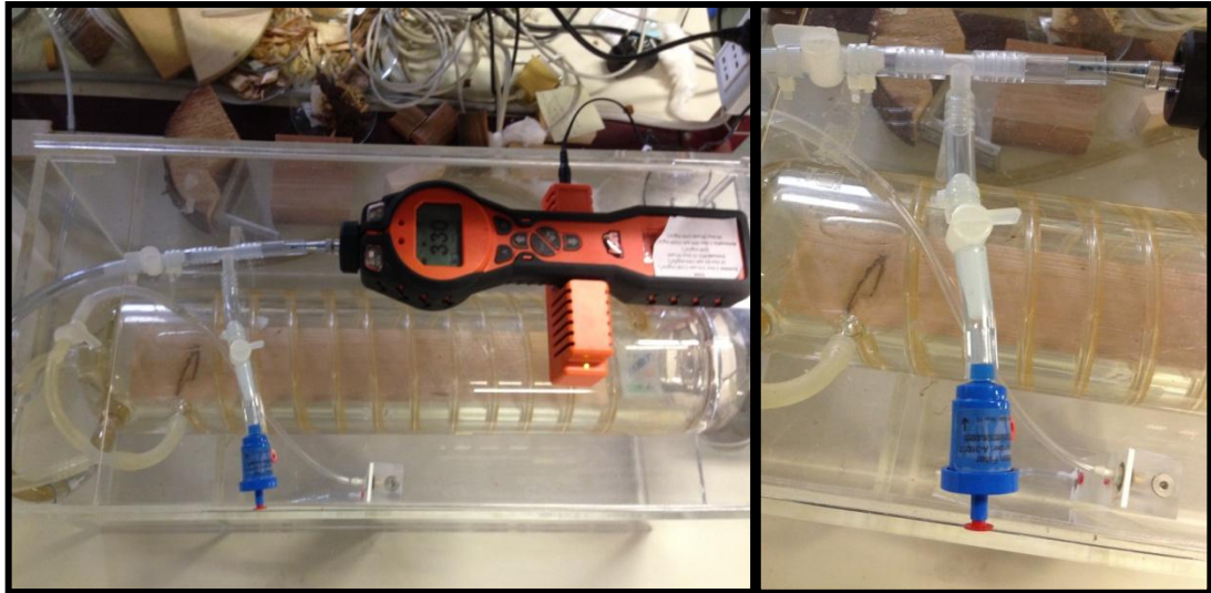
Figura 25: Azzeramento strumento con carboni attivi e sistema di valvole per il passaggio dell'aria allo strumento
