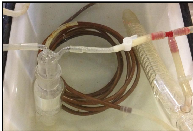
Figura 14: miscelazione del flusso saturo e secco mediante raccordo a T
