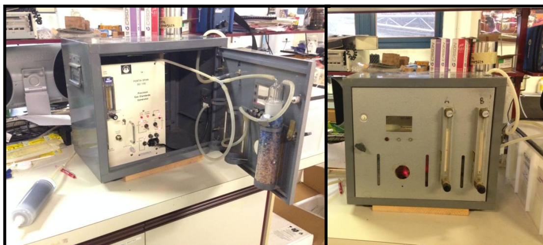
Figura 22: carboni attivi, sistema di pompaggio, silica gel, flussimetro
