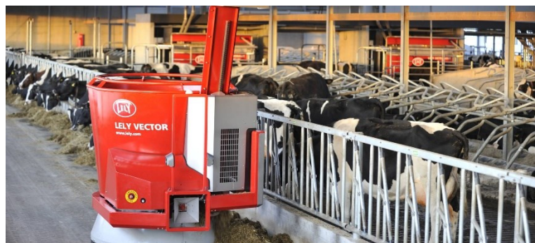
Figura 9: Sistema di alimentazione automatica per singoli capi
