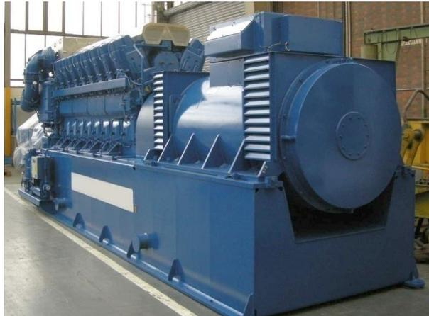
Un motore endotermico è generalmente fonte di vibrazioni, che si trasmettono all'albero del generatore e si scaricano in primis sui cuscinetti e quindi all'intera struttura, ecco che le varie componenti del generatore devono considerare tale disturbo e sopportarlo adeguatamente, senza che esso pregiudichi il buon funzionamento della macchina.
