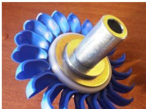
La turbina Turgo può lavorare con salti tra i 15 e 300 m. Come la Pelton è una turbina ad azione, però le sue pale hanno forma e disposizione diverse. Infatti il flusso colpisce le pale con un angolo di 20° rispetto al piano mediano della ruota entrando da un lato ed uscendo dall'altro. A differenza della
