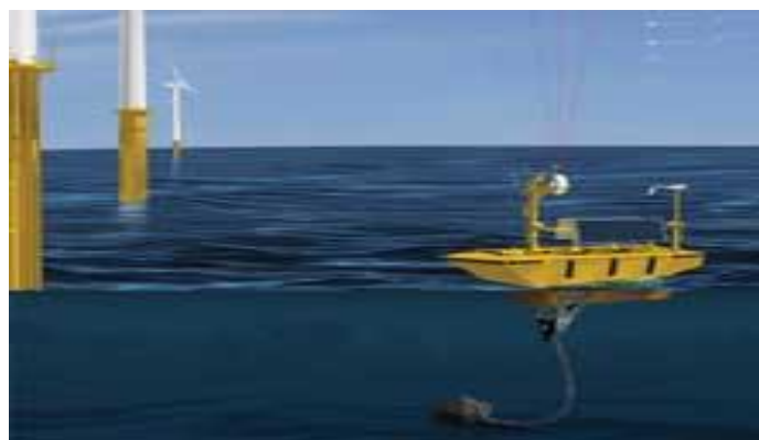
Figura 27. Windsentinel: misuratore anemologico offshore
