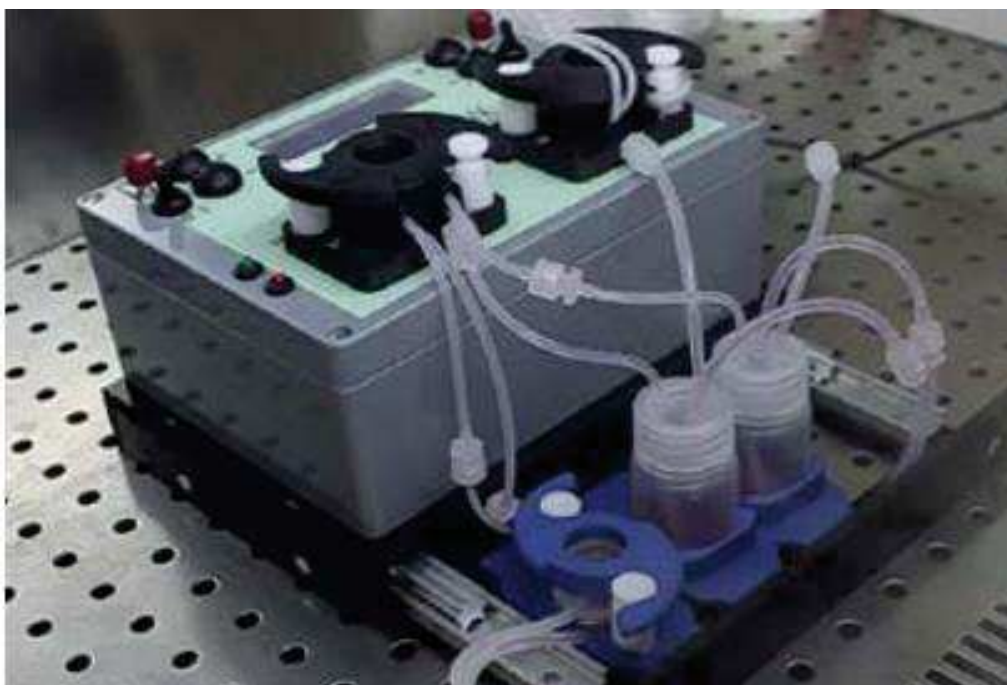
Figura 2 la figura rappresenta una foto dello strumento ivitech starter kit 2 utilizzato per la crescita del biofilm in dinamico.
