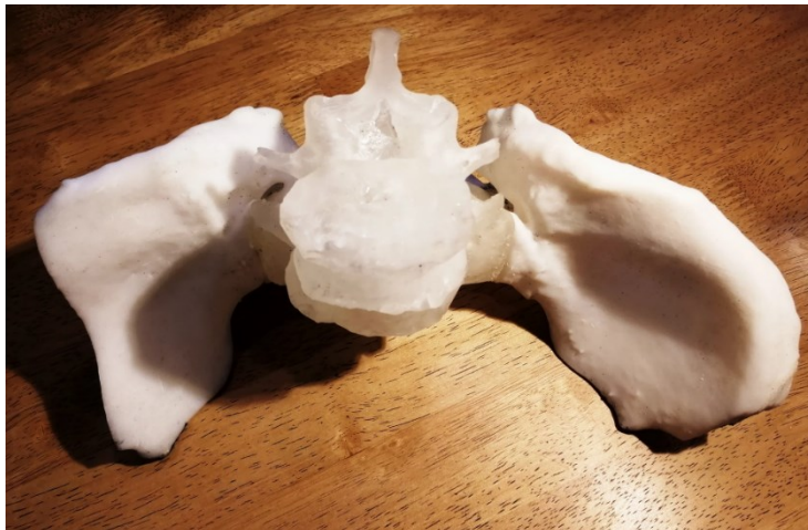
Fig. 4.5 – Modello stampa 3D della vertebra.
