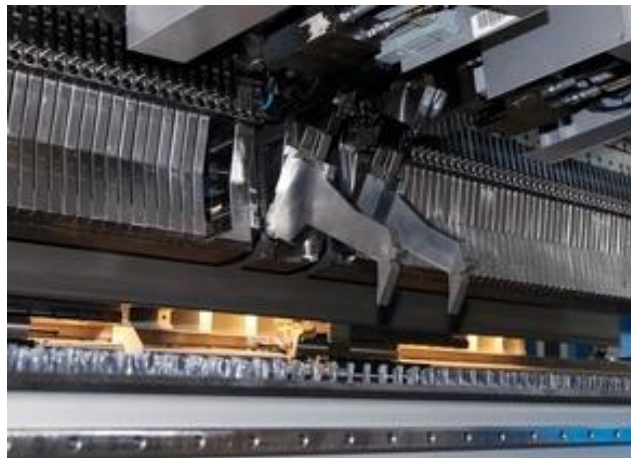
Figura 1.53: Illustrazione del premilamiera.[4]
