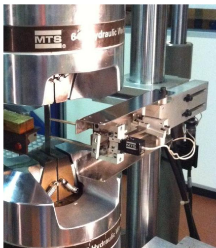
Figura 2.10: Illustrazione della prova in MTS con l'utilizzo dell'estensometro.
