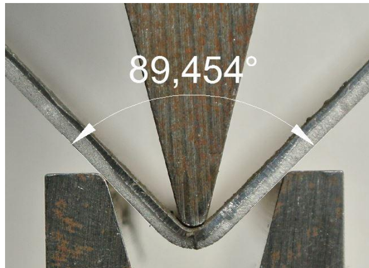
Figura 3.6: Procedura di misurazione dell'angolo di piega.
