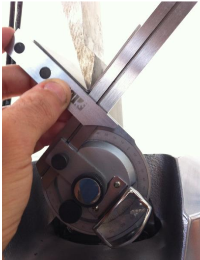
Figura 3.5: Procedura di misurazione dell'angolo di piega.
