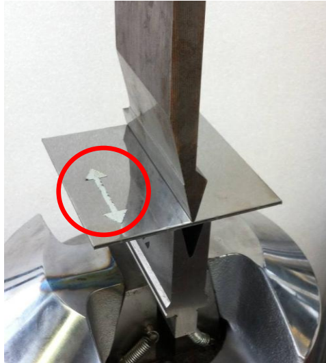
Figura 3.4: Considerazione della direzione di laminazione durante le prove di piega.
