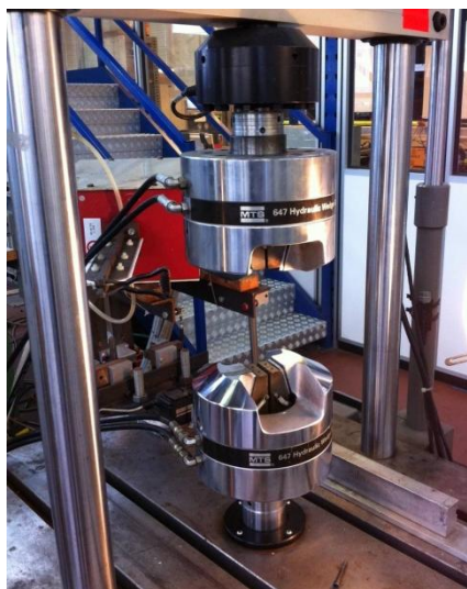
Figura 2.5: Foto macchina MTS per le prove di trazione.
