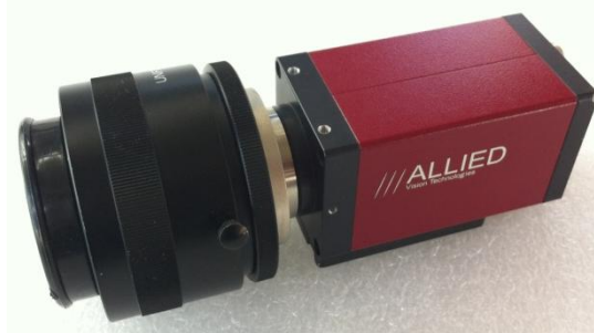
Figura 2.21: Fotocamera utilizzata per l'acquisizione delle immagini nelle prove di trazione.
