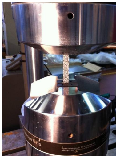
Figura 2.7: Provino con il pattern in macchina MTS.
