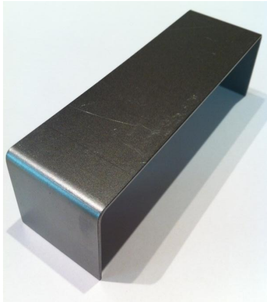
Figura 3.29: Provino di piegatura a prova terminata.
