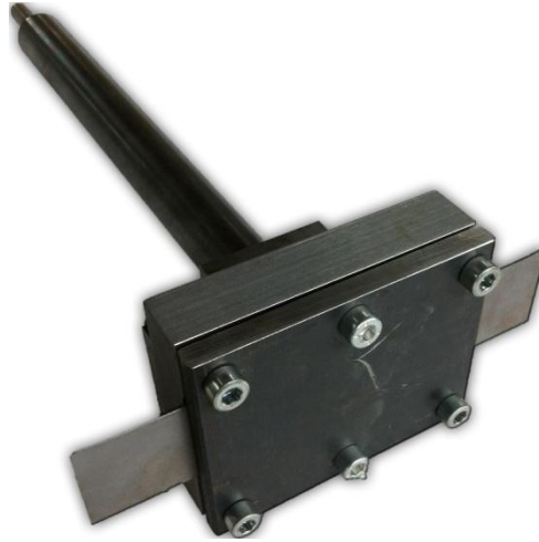
Figura 3.25: Set-up per inizio prova di piegatura.
