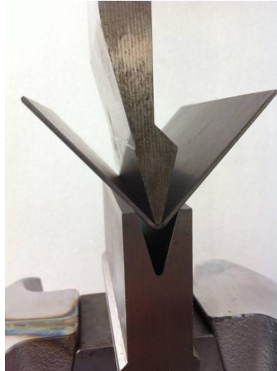
Figura 3.9: Prova di piegatura su DC01 Sp=1.5mm.
