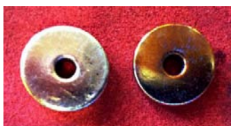
Figura 5.3 – Magnete permanente magnetizzato (a sinistra) e smagnetizzato (a destra). Si notano evidenti tracce di ossidazione dello strato protettivo superficiale dopo il trattamento termico di smagnetizzazione.
