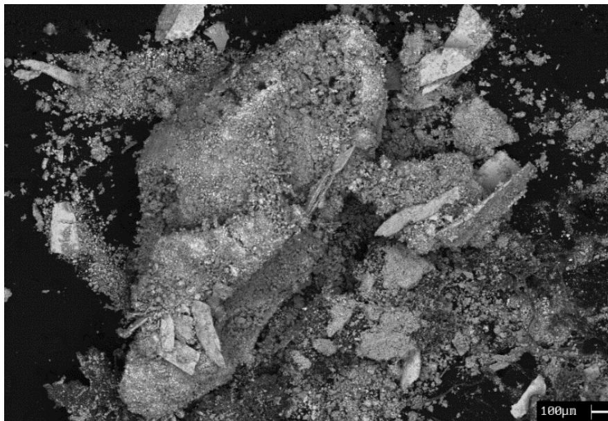
Figura 5.25 – Micrografia SEM del residuo di lisciviazione del test idrometallurgico con acido solforico (11).
