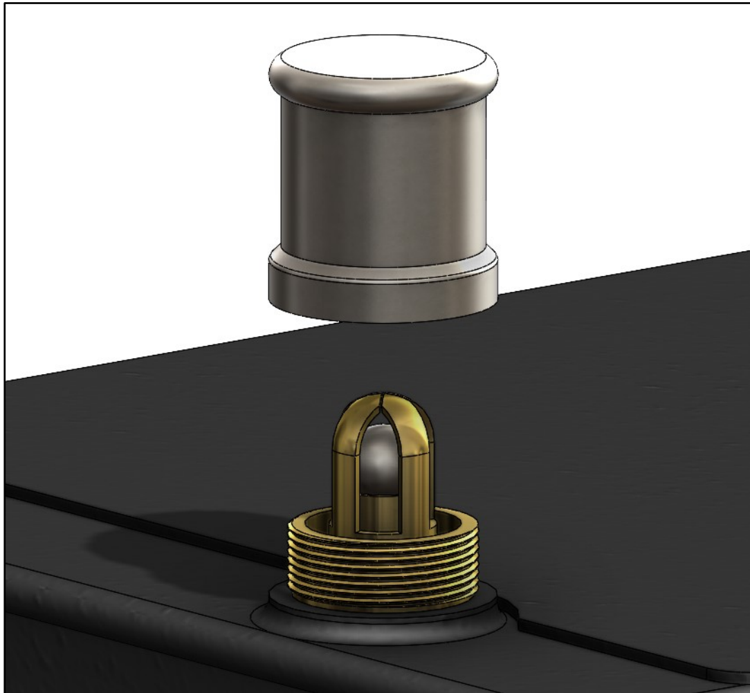
Fig. 26 e 27: dettagli della valvola sferica
