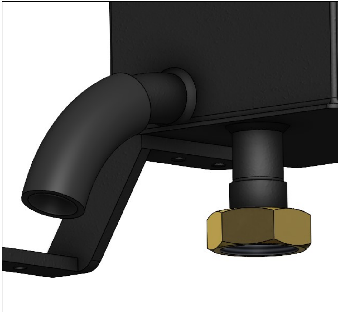
Fig. 30 e 31: dettagli del dado di raccordo
