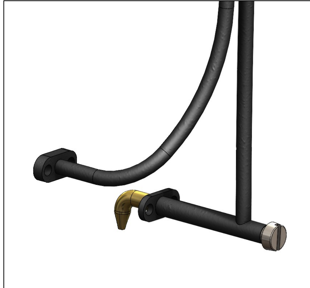
Fig. 32: dettaglio dei tubetti per i gas di scarico
