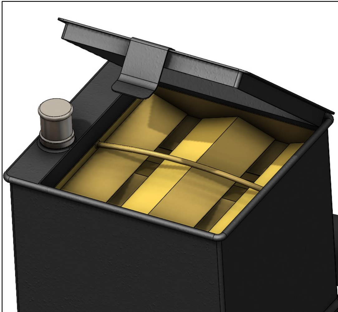
Fig. 28 e 29: dettagli della cassetta aperta, con e senza il telaio per la condensazione del vapore nei gas espulsi
