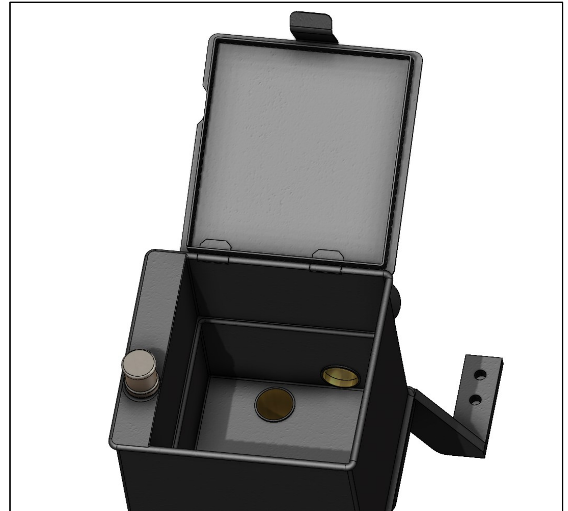
Fig. 28 e 29: dettagli della cassetta aperta, con e senza il telaio per la condensazione del vapore nei gas espulsi
