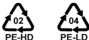
Figura 3.1 Simbolo del PE ad alta densità e a bassa densità. Il numero indica il tipo di plastica utilizzata (Piergiovanni & Limbo, Food Packaging - Materiali, tecnologie e qualità degli alimenti, 2010)
