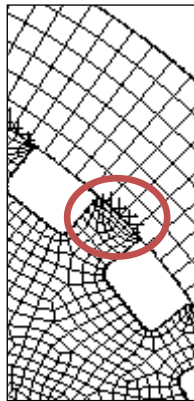
Figura 1.3.6: Dettaglio dell'arco di contatto tra albero e camicia
