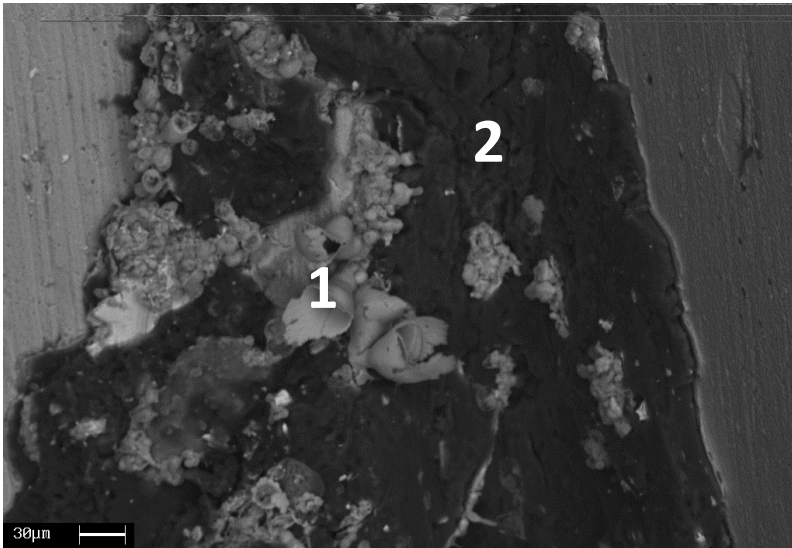
Fig. 5.151: Particolare del residuo morchioso sviluppato dal lubrificante sui maschi del gruppo H(1).
