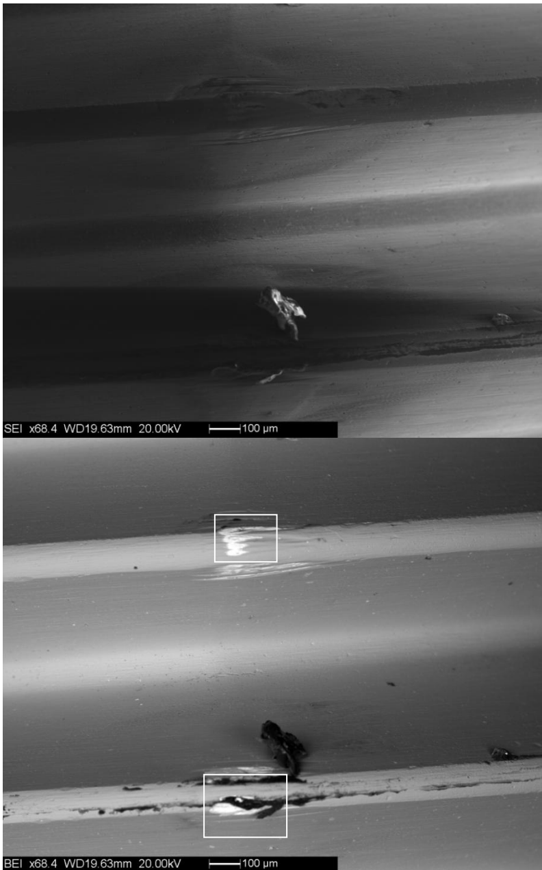
Fig. 5.35: Campione A5_L4-1, fenomeni di usura in corrispondenza del 2° e 3° filetto.
