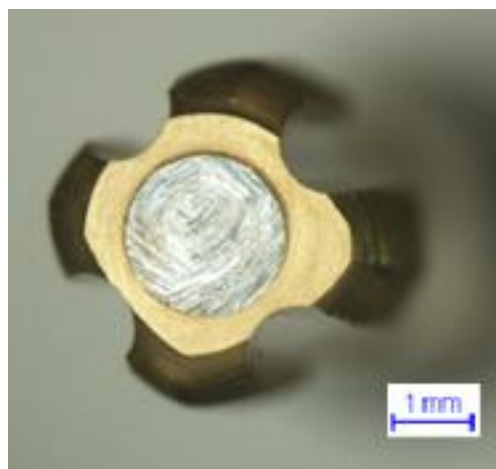
Fig. 5.52: Vista frontale (10×) del campione B1. Si notano bene le scanalature realizzate per favorire il passaggio di lubrificante.
