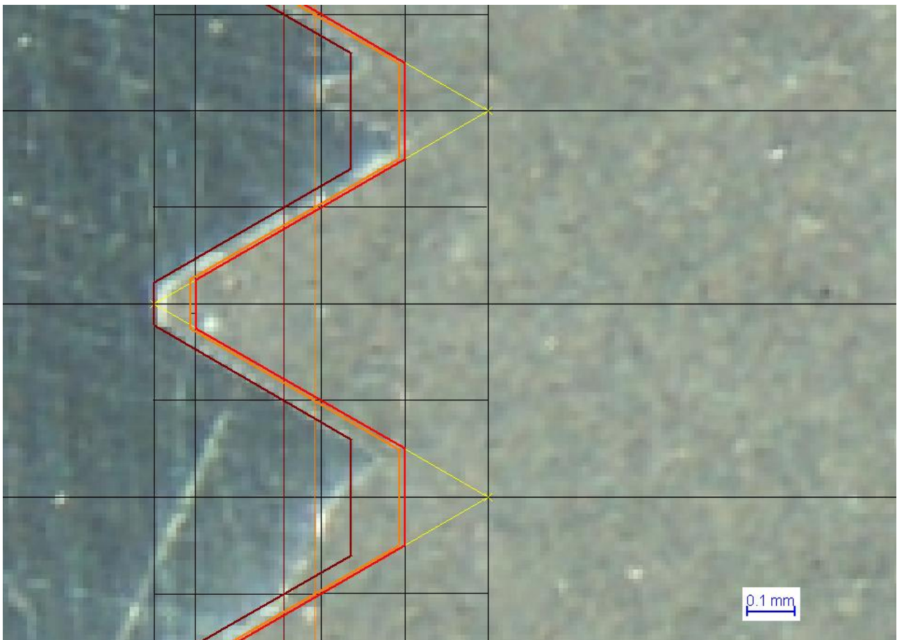
Fig. 4.19: Campione 03_a_sx (10×) con profilo di filettatura M5 \times 0,8 - 6G in tolleranza. Il profilo del filetto ricade all'interno della fascia di tolleranza.
