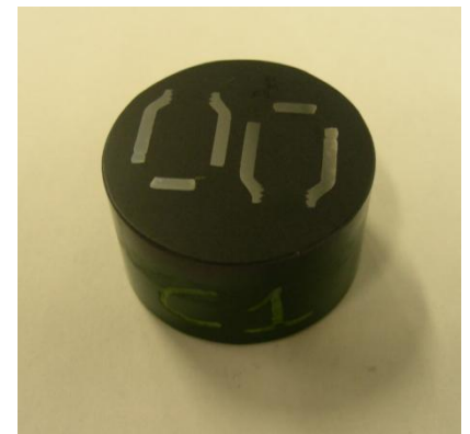
Fig. 2.13: Fotografia di un campione dopo le operazioni di rettifica e lucidatura.
