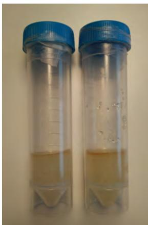
**Figura 6.7:** La provetta di sinistra contiene il cemento acrilico ottenuto mediante la Ricetta 02 mentre la provetta sulla destra contiene il cemento acrilico ottenuto mediante la Ricetta 01.
