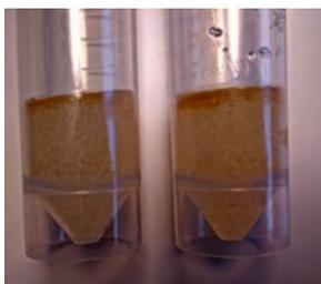
**Figura 6.8:** Ingrandimento sulla struttura del PMMA: è possibile notare come l'ingiallimento e la quantità di monomero residuo sia maggiore nella provetta sulla destra la quale corrisponde alla Ricetta 01.
