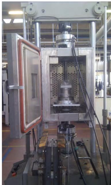
**Figura 4.11:** Montaggio dell'attrezzatura di prova sull'MTS 647 presente al laboratorio di Ingegneria Industriale a Padova.
