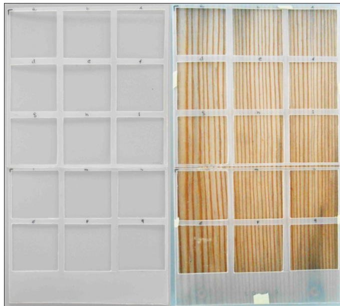
Figura 2.10 Mascherine e loro applicazione su un campione mediante nastro di carta
