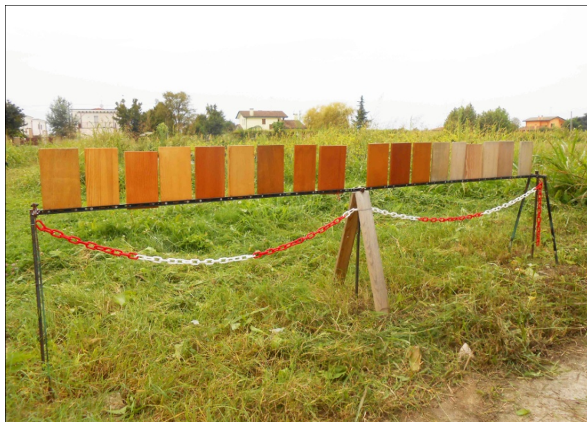
Figura 2.6 Campioni esposti ad invecchiamento naturale, modalità e sito di esposizione
