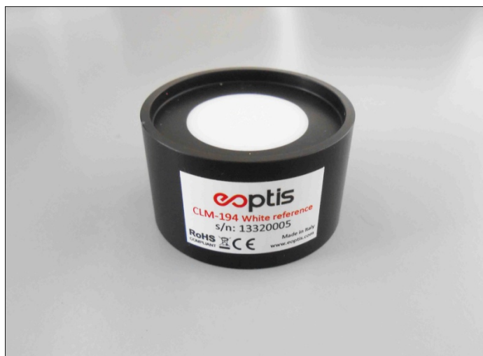
Figura 2.8 Bianco di riferimento per la calibrazione del colorimetro Eoptis CLM-194
