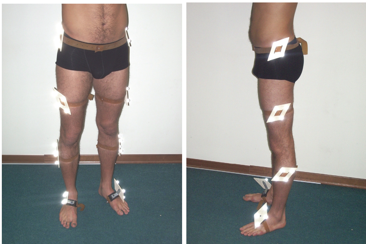
Fig 3.5 Disposizione delle placche rigide con i marker secondo il protocollo CAST [2].
