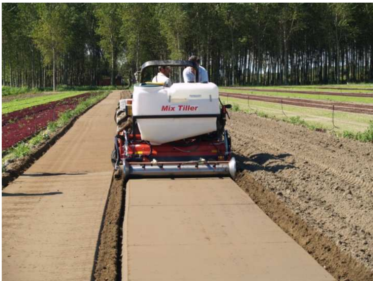
Figura 5.1 – Mix Tiller in avanzamento; si noti l'auola di coltivazione.
