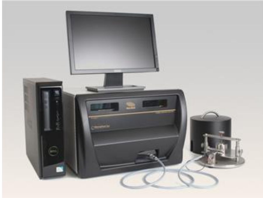
Figura 5.6. Conduttivometro TPS 2500 S Hot Disk®.
