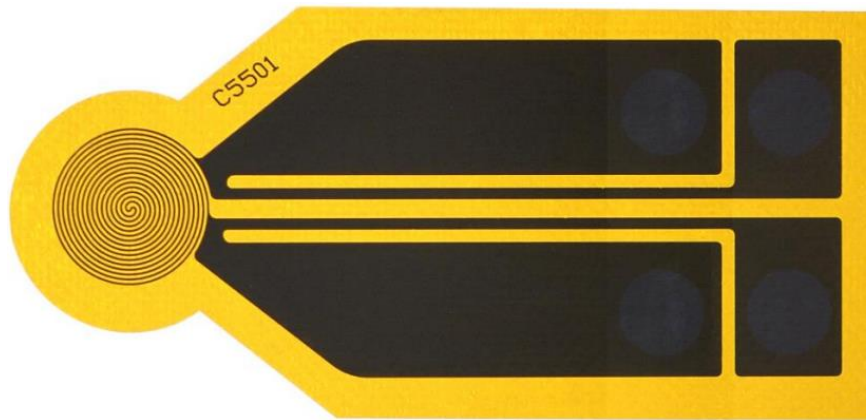
Figura 5.5. Geometria sensori metodo TPS.
