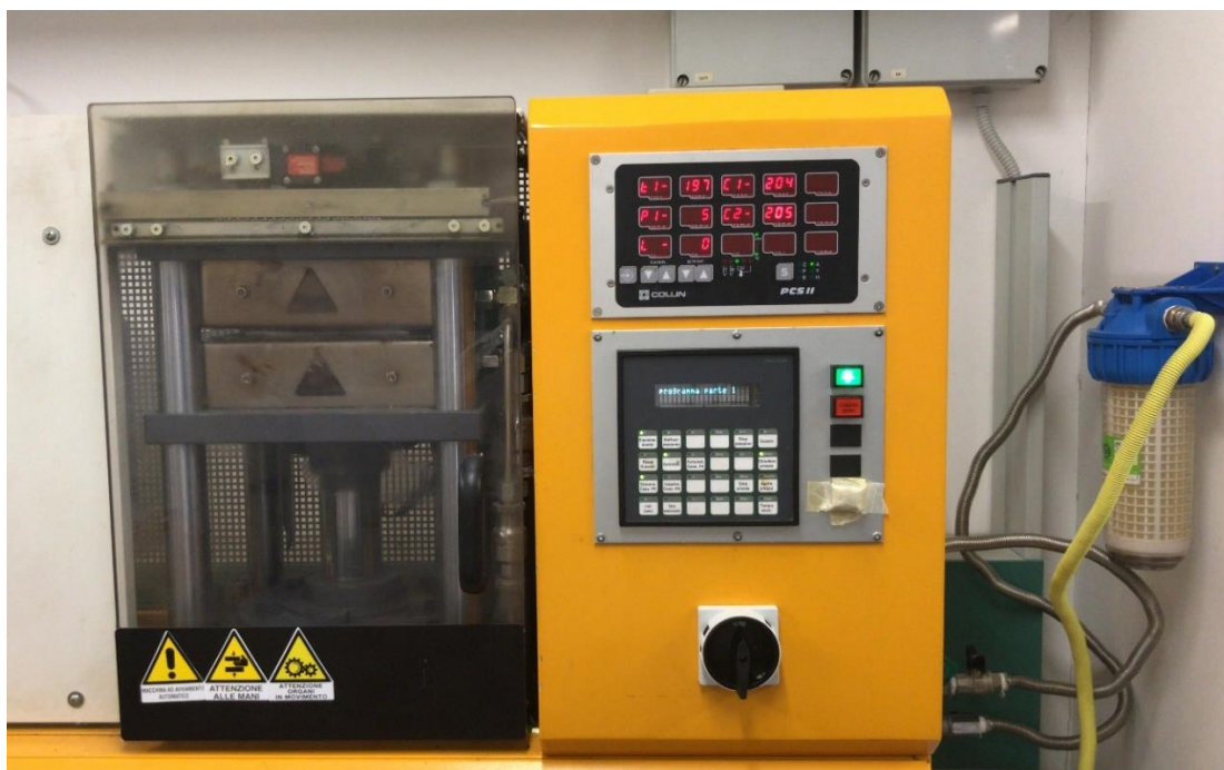
Figura 6.6. Pressa a compressione COLLIN® P200 P utilizzata sperimentalmente.
