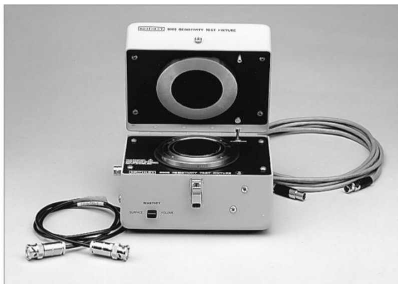
Figura 6.10. Camera porta-campione elettrometro Keithley 6517B utilizzato sperimentalmente.
