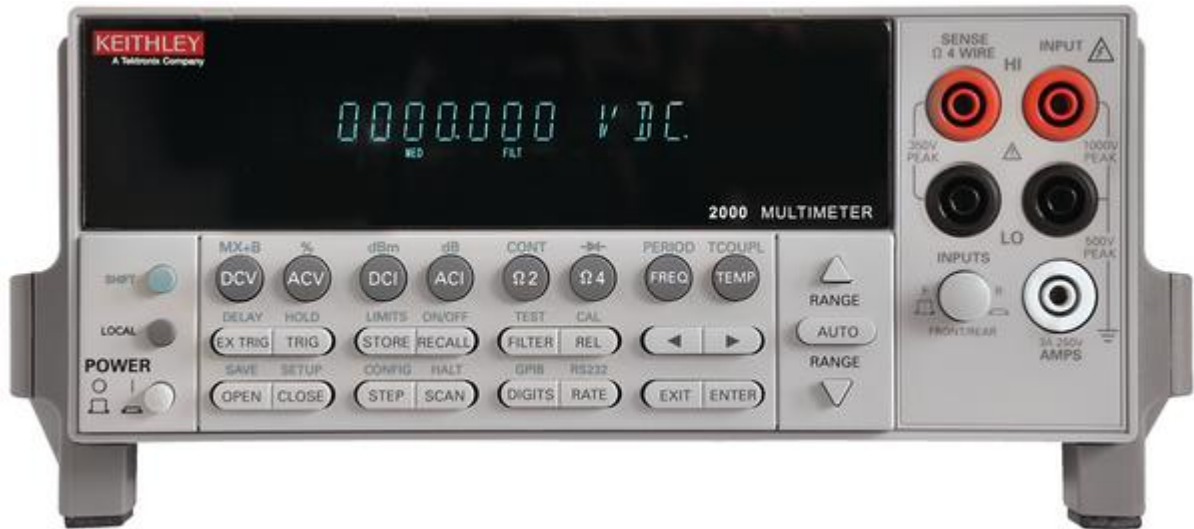
Figura 6.11. Keithley model 2000 multimeter utilizzato sperimentalmente.
