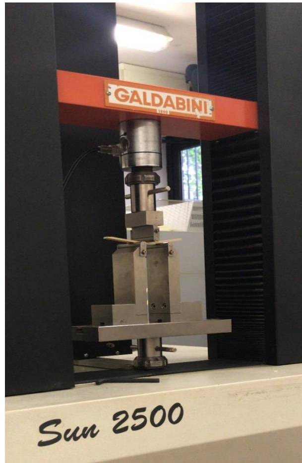
Figura 6.7. Dinamometro Galdabini Sun 2500 utilizzato sperimentalmente.
