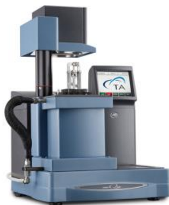
Figura 7.3. DMA Q800 utilizzata sperimentalmente.
