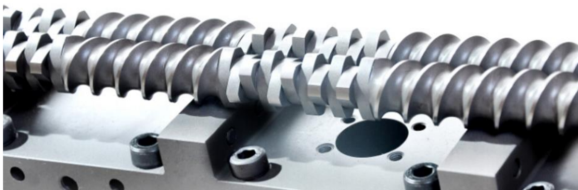
Figura 4.3. Profilo vite nel quale sono evidenziate le fasi di trasporto e i masticatori.
