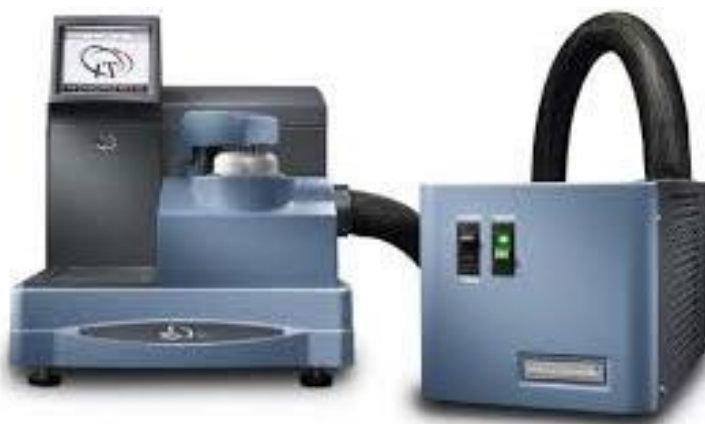
Figura 6.13. DSC Q200 utilizzata sperimentalmente.
