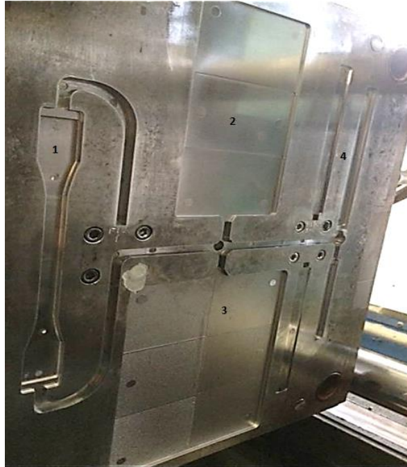
Figura 6.5. Stampo utilizzato. La forma 1 rappresenta il provino ad osso di cane, le placchette 2 e 3 sono rispettivamente placchette liscia a tre spessori e gofrata, le forme 4 rappresentano provini ASTM e ISO.
