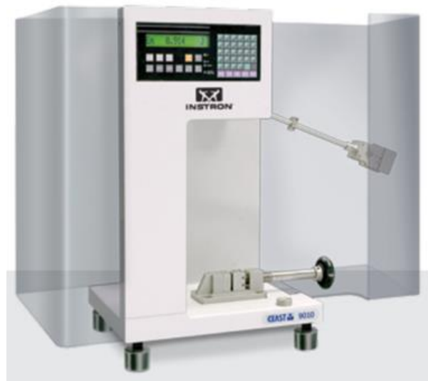
Figura 6.8. Pendolo CEAST 9010 per misurare la resistenza all'impatto.
