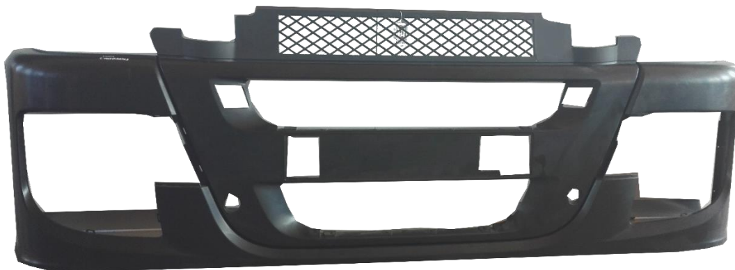
Figura 1.5. Paraurti di un camion IVECO realizzato in PP compound caricato 20% talco.
