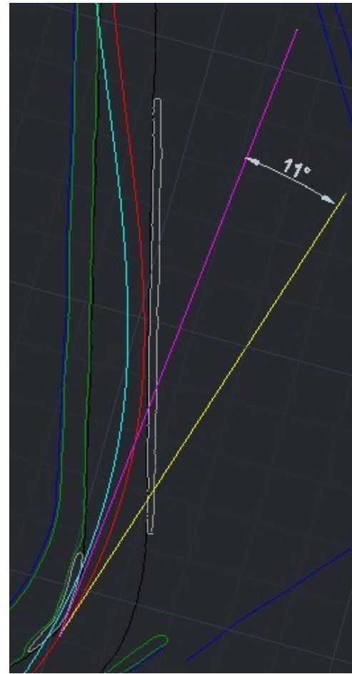
Traiettoria della monoposto (linea magenta) visualizzata nel modello AutoCAD e relativo angolo formato con la tangente (linea gialla) alla traiettoria ideale, nel punto iniziale.
