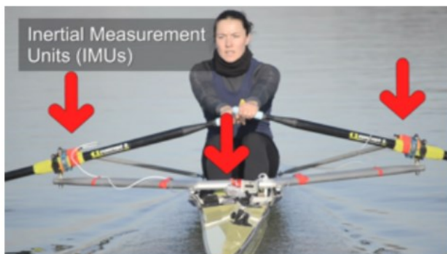
Fig. 5. Implementazione della rete di sensori: tre IMU sui remi e sulla barca, indicati dalle frecce rosse. [2]
