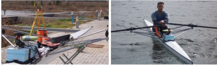
Fig. 4. La configurazione di GPS e MEMS-IMU utilizzata durante i test preliminari a Shinias al Centro Olimpico di canottaggio e canoa. [7]
