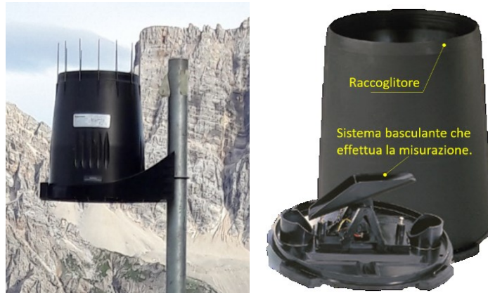
Figura 28. Pluviometro a bascula (la foto di sinistra è stata scattata dall'autore)
