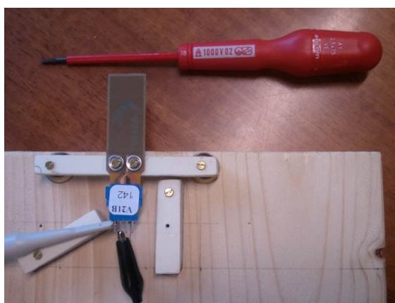
Figura 8.6: Configurazione sonda passiva – morsetti del cantilever e cacciavite da elettricista
