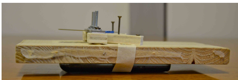
Figura 8.12 Configurazione eccitata alla base da telefonino Samsung GT-I9003
