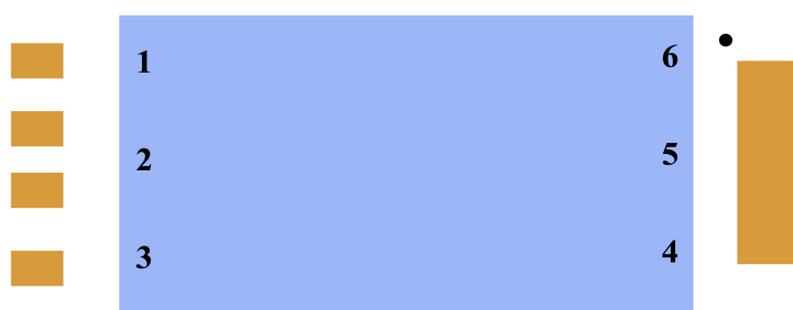
Figura 7.5: Deposito nitruro di alluminio 4 bollini 1 striscia
