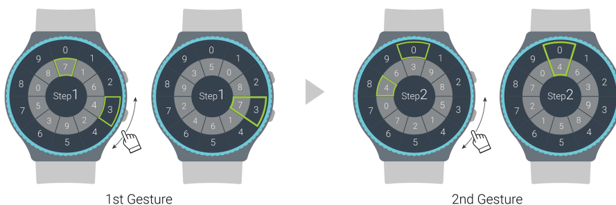
Figura 3.3: Funzionamento Two Gesture Pin
