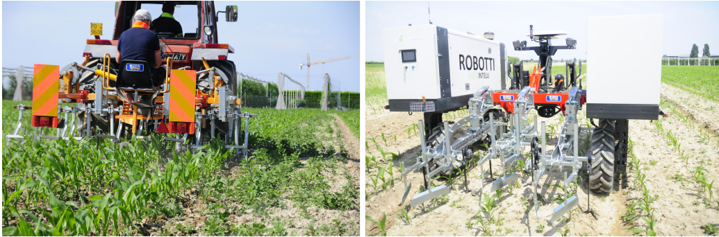
Figura 17: I cantieri di lavoro della sarchiatura: trattore convenzionale (sinistra) e Robotti 150D (destra).
