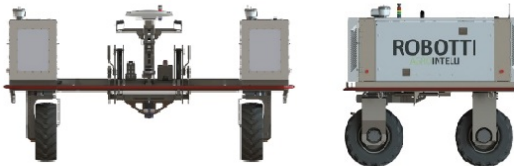
Figura 9: Visione frontale e laterale Robotti 150D.
