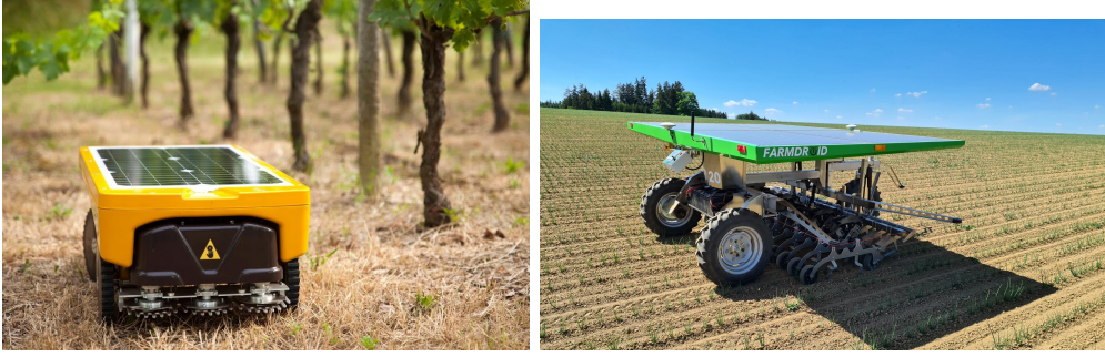
Figura 2: Esempi di agrobot a propulsione elettrica e specializzati. A sinistra "Vitirover" per il diserbo meccanico in colture arboree e a destra "Farmdroid" per la semina e il diserbo meccanico in pieno campo.
