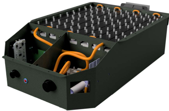
Fig. 1.2.1.1. Render del pacco batteria di alta tensione
