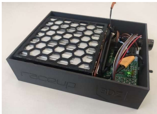
Fig. 3.2.2. Foto del sistema completo di batteria e BMS, nella scatola stampata in 3D.
