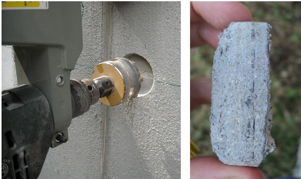
Figura 3.39: a sinistra il tentativo di incisione sulla striscia di ALBARIA STRUTTURA applicata al modulo A4 in pietra, a destra il tassello che si è staccato dal supporto.
