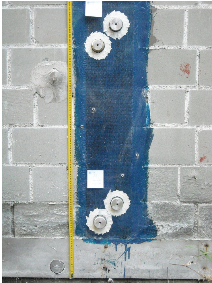
Figura 3.48: modulo B2 in pietra con applicazione dei dolly ;
