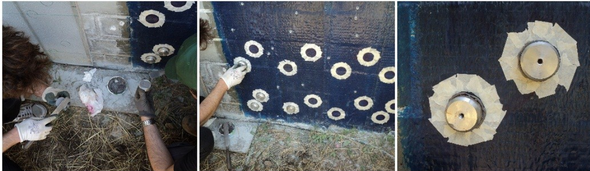
Figura 3.44: fasi di incollaggio dei dolly mediante Concresive ;
