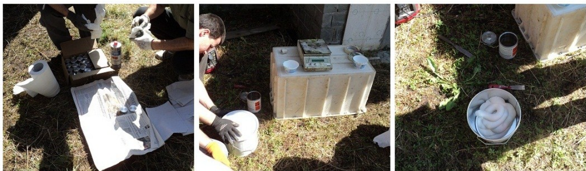
Figura 3.43: fasi di pulizia dei dolly e di preparazione del Concresive ;
