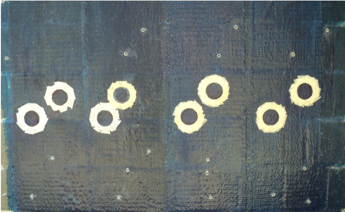
Figura 3.42: protezione con scotch delle incisioni eseguite sul modulo A4 in pietra;
