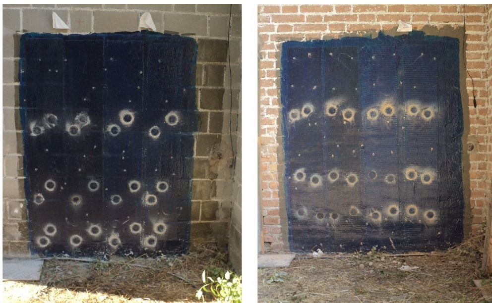
Figura 3.38: incisioni su i moduli A4 e B4 con applicazione di MBrace Saturant Adesivo con fibre di carbonio e con fibre di vetro .
