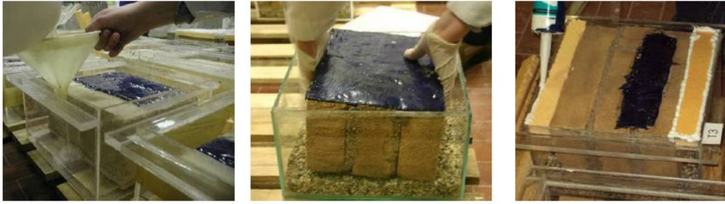
Figura 1.7. Alcune fasi del test sulla cristallizzazione [Binda et al. , 2011].
