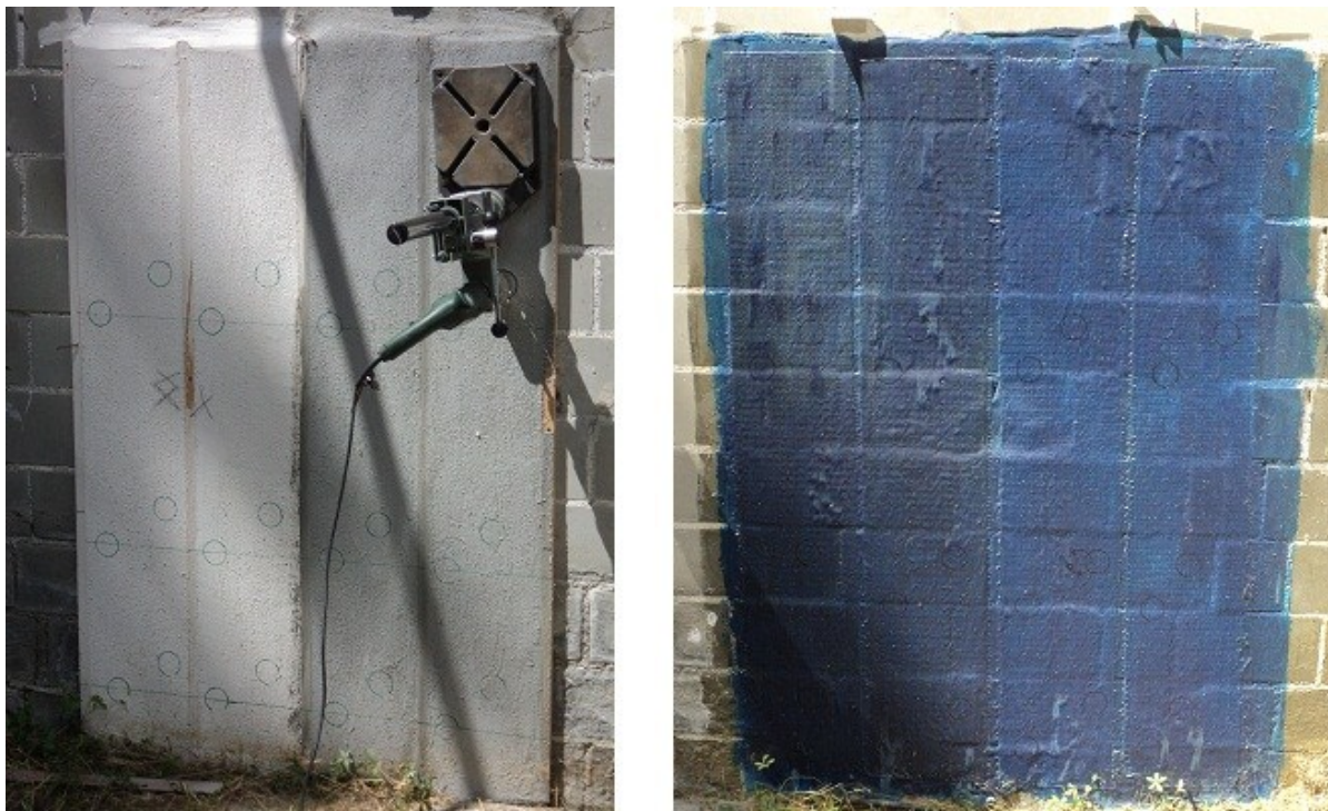
Figura 3.35: modulo A4 in pietra con tracciate le impronte dei dolly; a sinistra le impronte sull'applicazione di ALBARIA STRUTTURA e EMACO R955M, a destra sull'applicazione di MBrace Saturant Adesivo con fibre di carbonio e con fibre di vetro;
