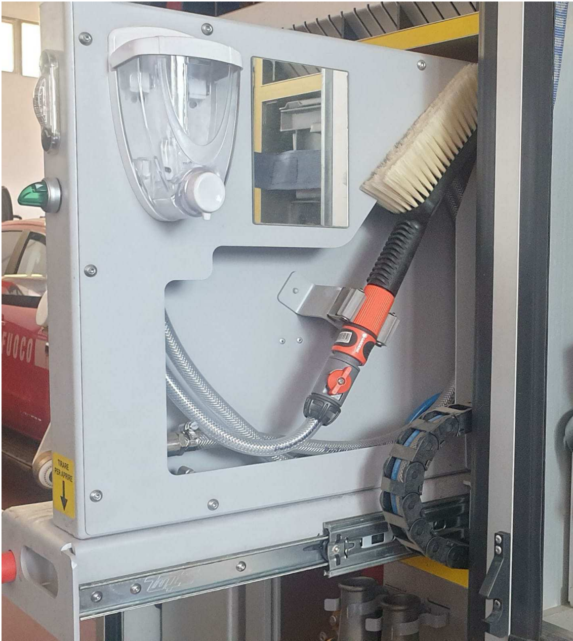
Figura 9 Particolare della spazzola connessa all'aspiratore, montata a bordo dell'APS del Comando di Novara
