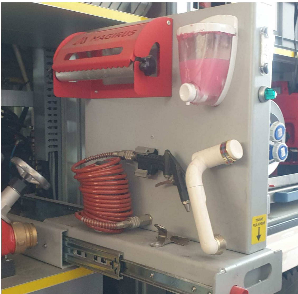
Figura 10 Altro particolare della pistola ad aria compressa per soffiare i DPI e kit per il lavaggio dell'operatore
