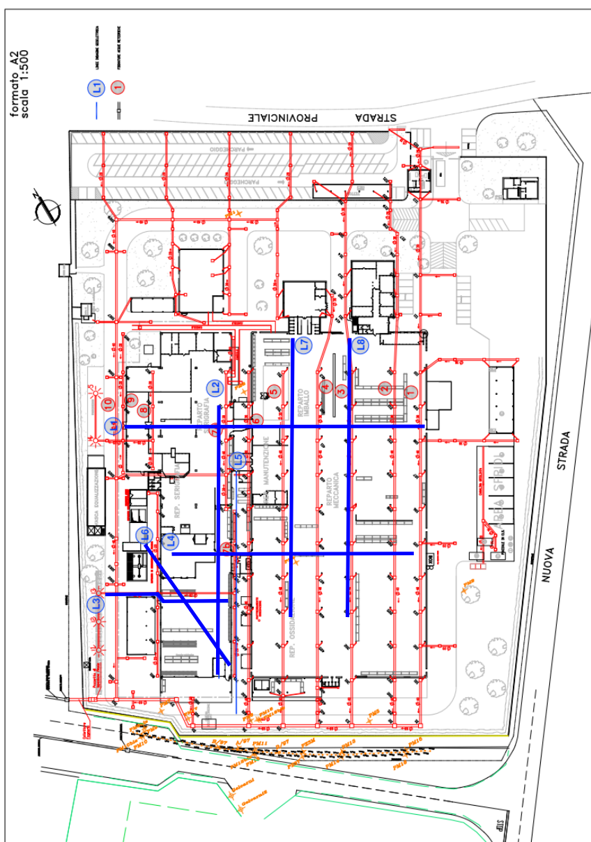
Fig. 3.13: Linee ERT (in blu) acquisite durante la FASE 2. Si sottolinea che la linea L5, originariamente pianificata, non sia stata acquisita a causa della presenza nella zona della rete di dispersione dell'impianto di messa a terra. Immagine tratta da (Cassiani, 2018c)
