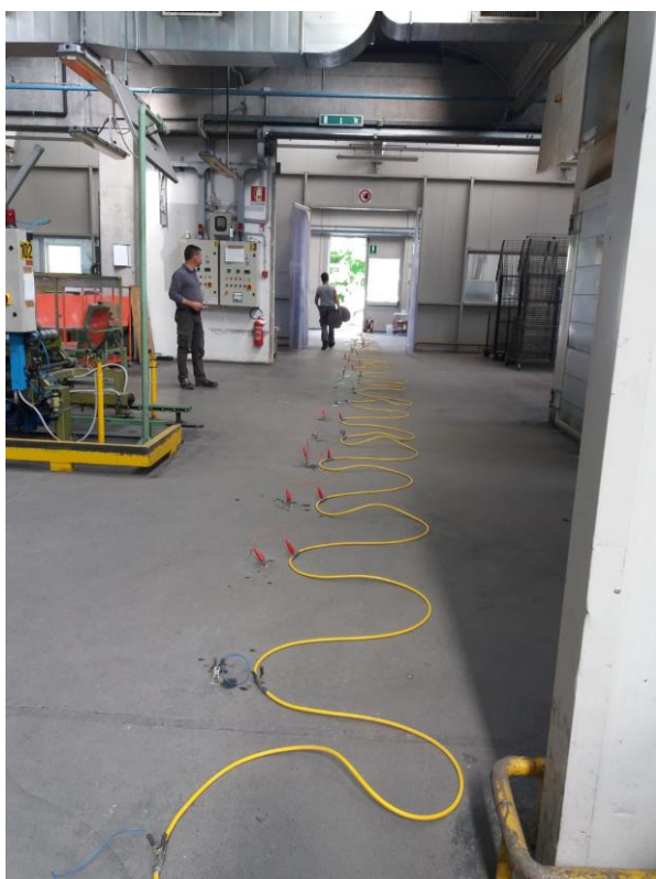
Fig. 3.14: Acquisizione della linea ERT L4 il 7 maggio 2018.
