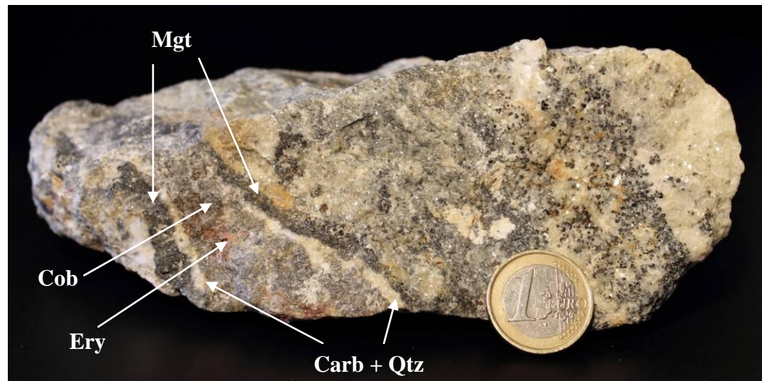
Fig. 4. Campione raccolto in corrispondenza dell'affioramento mineralizzato a cobaltite al margine sud della 1° Massa Ferriere al livello 860. Sottili bande carbonatiche (Carb), con quarzo subordinato (Qtz), separano una vena di cobaltite (Cob) da due bande a magnetite (Mgt). Si noti la presenza di patine rosate di eritrite (Ery) sulla superficie della vena a cobaltite, e la distribuzione a “fiamme” delle disseminazioni di magnetite nella porzione destra del campione.
