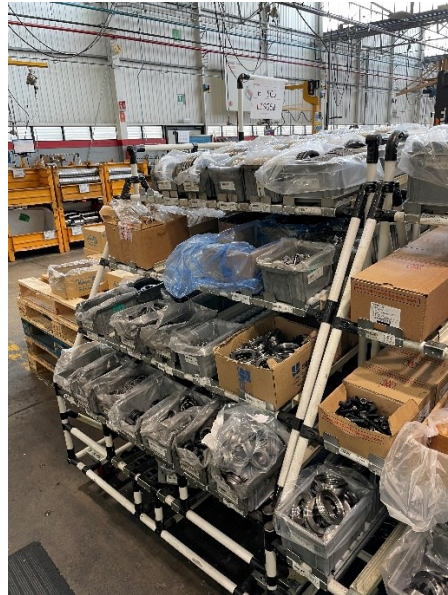
Figura 4.2: Esempio di scaffale a gravità in cui sono presenti codici di minuteria sia in cartone che in plastica
