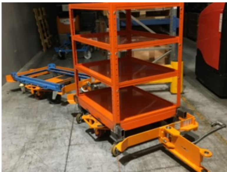
Figura 5.9: Prototipo di carrello multilivello a 4 livelli
