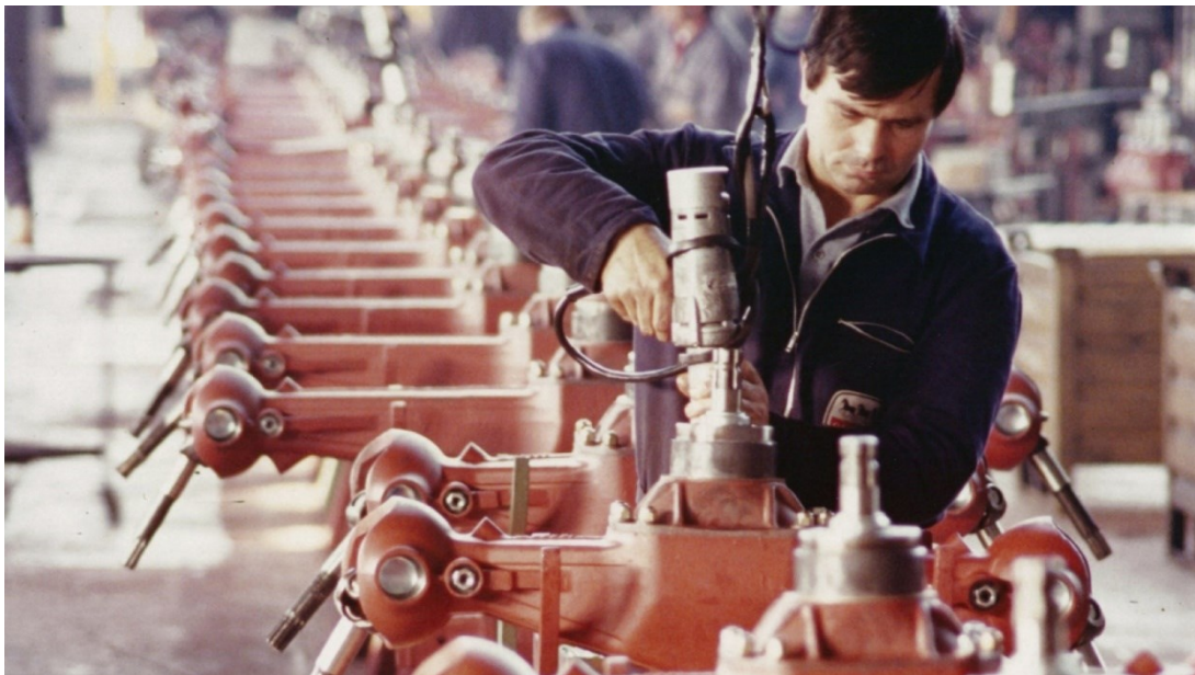
Figura 1.3: Linea di montaggio per assali a Campodarsego (anni '80)
