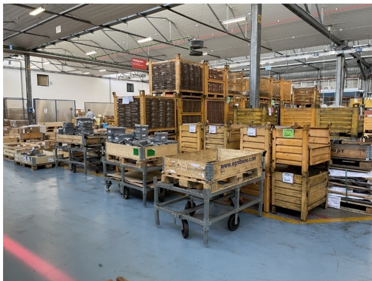
Figura 4.22: Esempio di restringimento della corsia davanti all'ACEMA a causa dei carrelli da riempire e dei pallet di pre-stoccaggio
