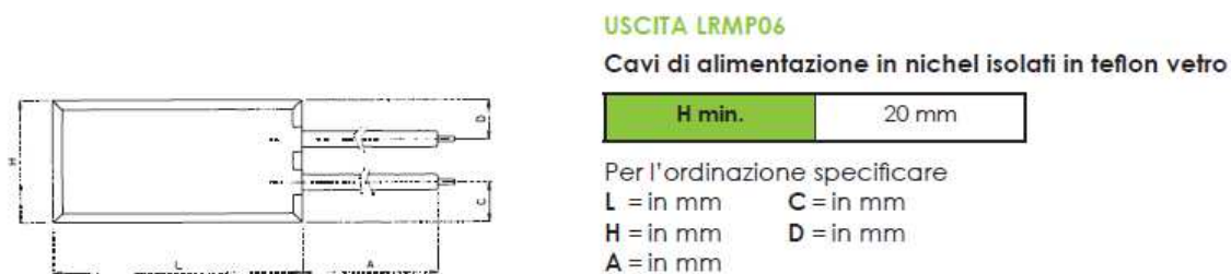
Figura 49: Dimensioni riscaldatore piatto isolato in ceramica, adattata dal catalogo Lorenzoni®
