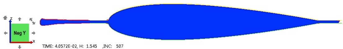
Figura 4.46 – Analisi della presenza di pieghe nel materiale. Per esigenze tipografiche si è omessa la legenda. Il colore uniforme blu indica l'integrità del forgiato
