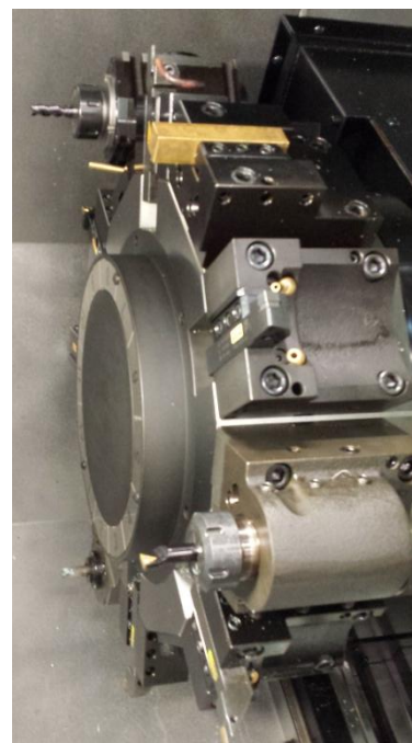
Fig. 4-28 : a sinistra il mandrino del tornio, a destra la torretta porta utensili.
