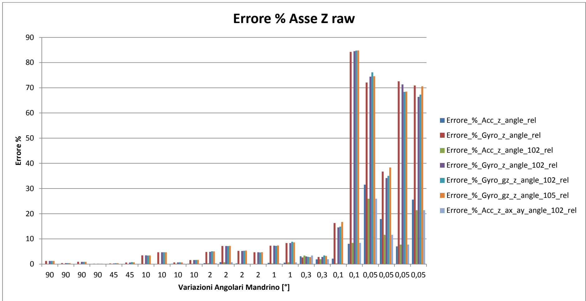
Fig. 6-17 : Istogramma dell'errore percentuale di misura dell'angolo attorno all'asse z, al variare delle funzioni utilizzate per calcolarlo, la prima cifra del numero contenuto nell'etichetta di ogni funzione indica l'ordine del filtro, mentre le ultime due cifre indicano la frequenza di taglio normalizzata (102 = filtro del primo ordine con frequenza di taglio pari a 0,2). Se nell'etichetta sono indicati i nomi delle misure da cui sono stati ricavati gli angoli "gz, ax, ay" significa che queste sono state l'oggetto del filtro, altrimenti il filtro è stato applicato all'angolo calcolato sui dati originali.
