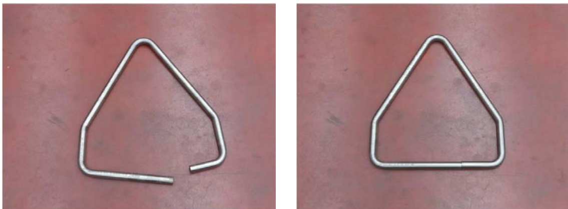
Fig. 1-21 : Componente geometricamente sbagliato a causa del ritorno elastico (sinistra) e componente corretto (destra). (2)
