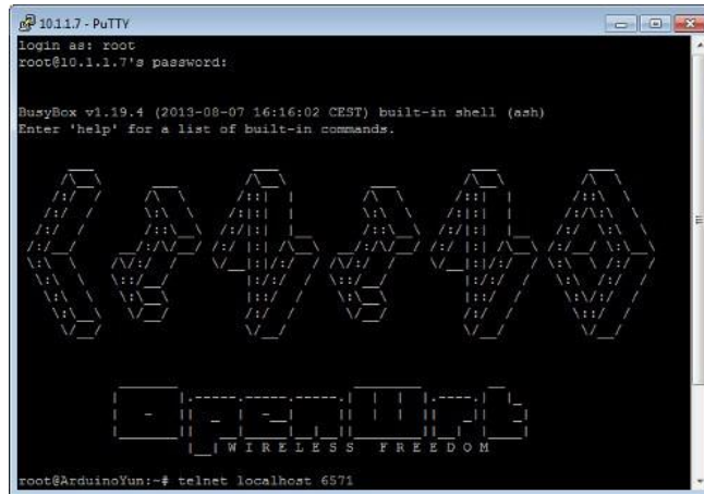
Fig. 4-10 : Screenshot di Putty in esecuzione, al momento dell'autotenticazione su Arduino Yún.
