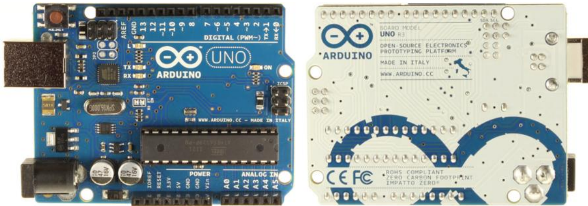
Fig. 4-6 : Microcontrollore Arduino Uno, a sinistra la parte frontale a destra il retro della scheda. (32)
