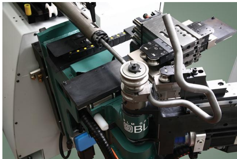
Fig. 1-13 : Piegatrice a controllo numerico, modello SMART, della BLM GROUP s.p.a. , per operazioni di "draw bending" e "roll bending". (3)
