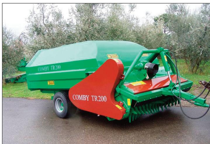
Figura 4.14 - Trinciacaricatrice con ampio cassone
