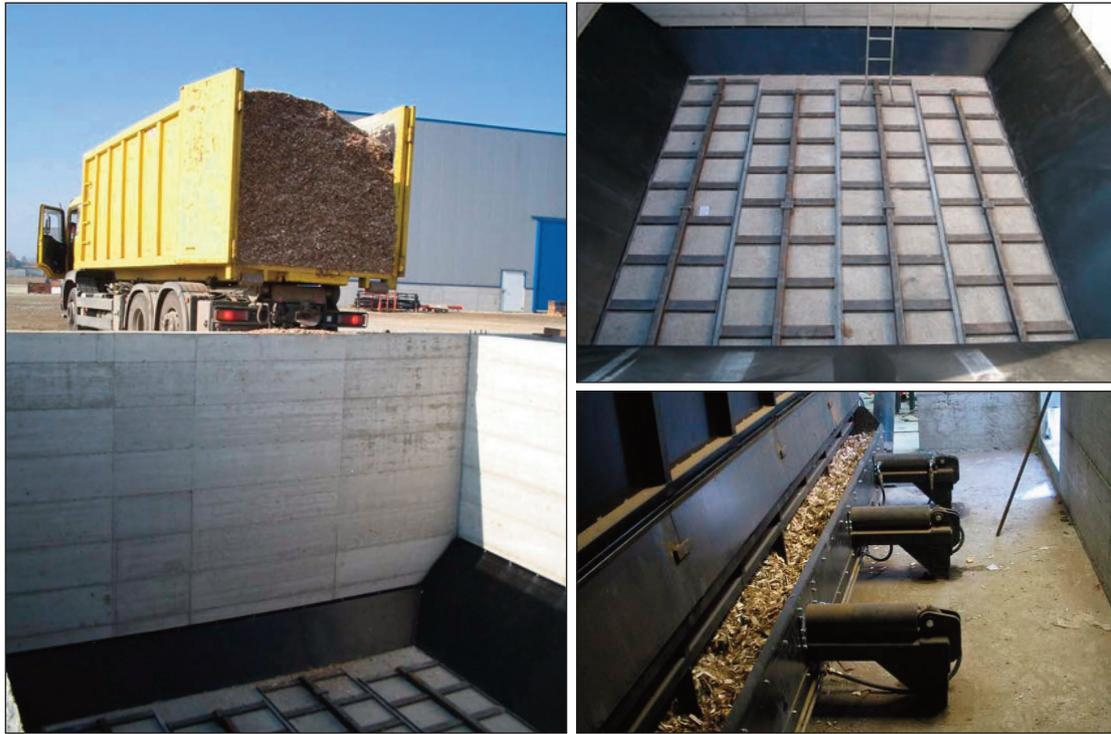
Figura 5.22 - Esempio di silo di stoccaggio munito di estrattore a rastrelli idraulico
