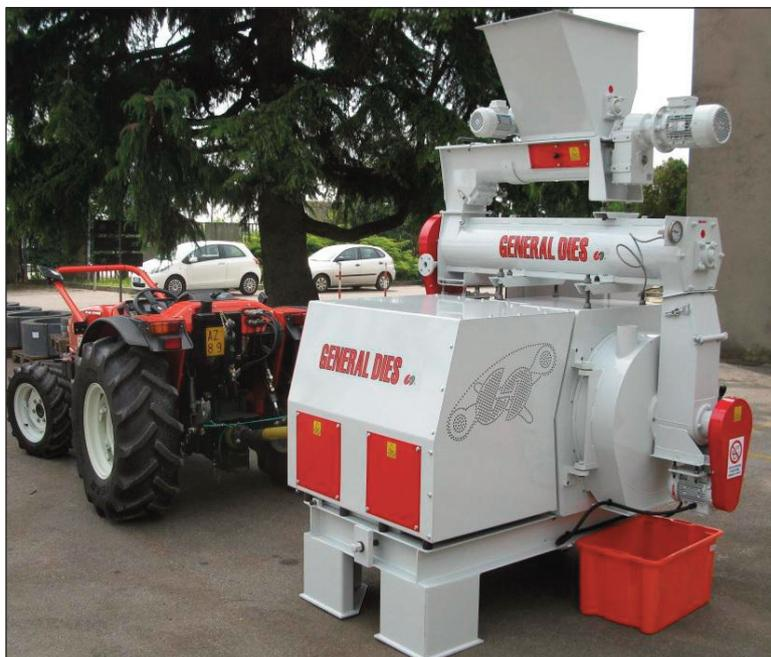
*Figura 4.31 - Pellettatrice mobile alimentata dalla presa di forza di un trattore agricolo attraverso un cardano.*
