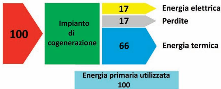
Secondo lo schema di *figura 5.24* si avrebbero a disposizione circa 660 kW termici da destinare al riscaldamento radiante per esempio di capannoni industriali, uffici o serre nel periodo invernale.
