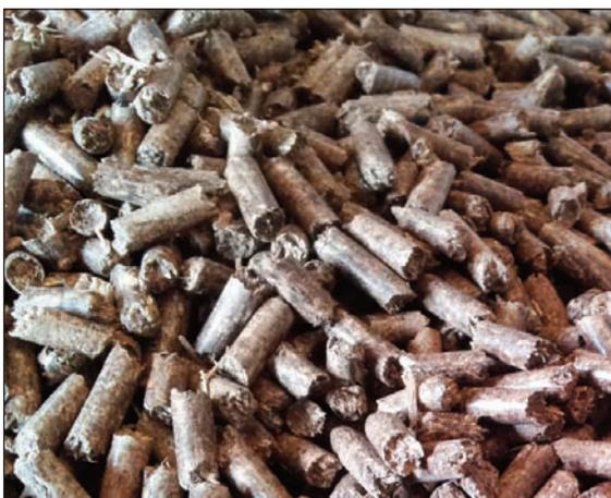
Figura 4.9 - Pellet di vite
