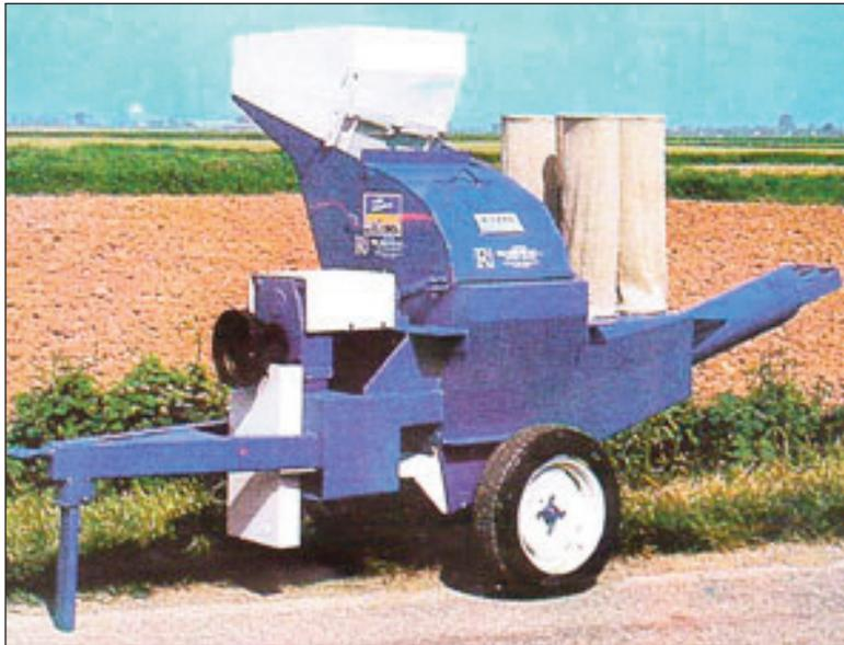
*Figura 4.30 - Raffinatore mobile alimentato dalla presa di forza di un trattore agricolo attraverso un cardano.*
