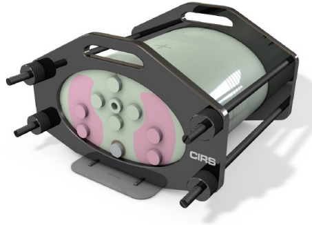
Figura 20. Fantoccio IMRT Phantom Thorax
