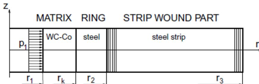
Fig 1 modello cilindrico del contenitore composto per alte pressioni con parte esterna nastrata
