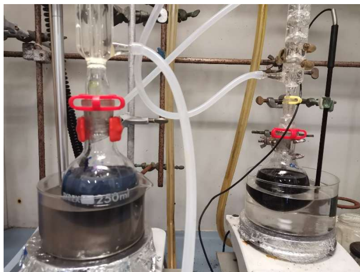
Figura 5.2 – Foto realizzata per mettere in evidenza il contrasto tra il colore viola scuro della miscela IDA_3T_Bi e il colore nero di IDA_3T_Sb durante la fase di transmetallazione
