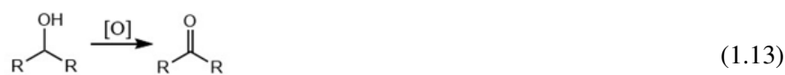
Figura 1.6 – (1.12) Reazione di ossidazione di un alcol primario ad aldeide e acido carbossilico; (1.13) Reazione di ossidazione di un alcol secondario a chetone
