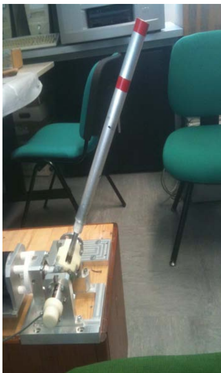
Figura 2.2: Struttura fisica utilizzata per il test (Joystick).
