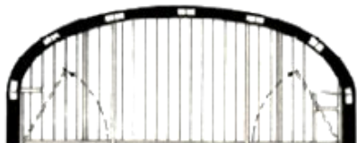
Figura 26 copertura voltata modello "Apollonio Padova" del bivacco Comici 1962
