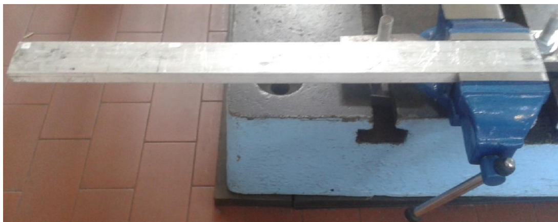
Fig.4.26-miglioramento del vincolo tramite l'utilizzo di un basamento solido
