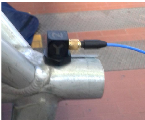
Fig.2.10-applicazione dell'accelerometro durante un test di laboratorio.
