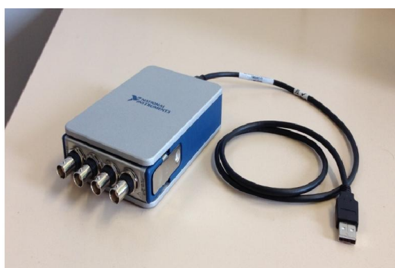
Fig.2.11-sistema per l'acquisizione dei dati NI DSA 9234.
