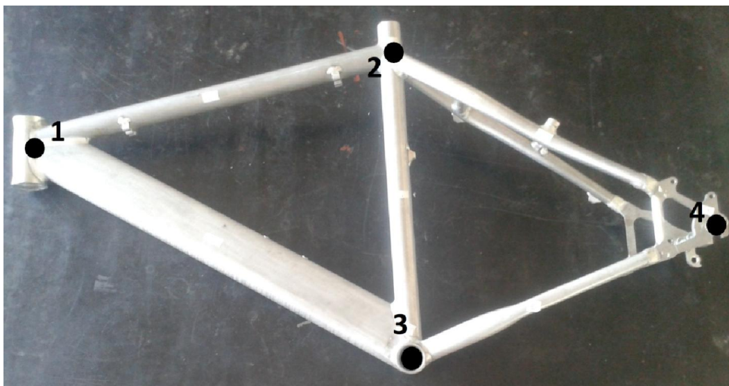
Fig.5.1-telaio usato per le prove sperimentali, con relativa numerazione dei nodi individuati.
