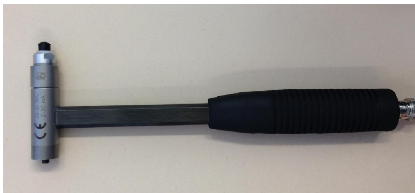
Fig.2.8-martello strumentato per analisi modale.
