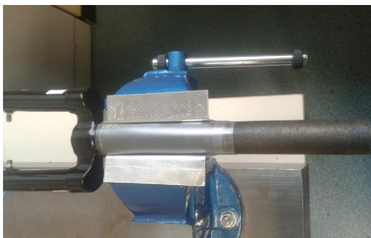
Fig.6.2-dettaglio del vincolo applicato alla forcella.
