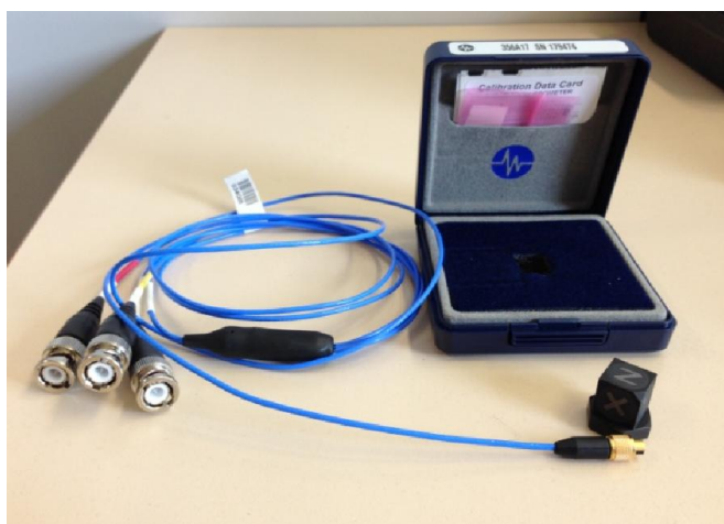
Fig.2.9-accelerometro piezoelettrico triassiale usato nelle prove di laboratorio.
