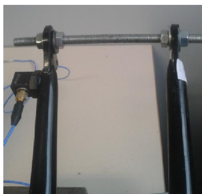
Fig.6.3-dettaglio del perno che tiene uniti i 2 foderi..
