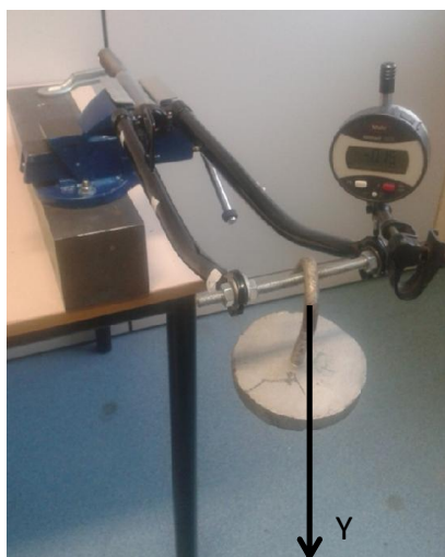
Fig.6.14-test per la rigidzza statica longitudinale.
