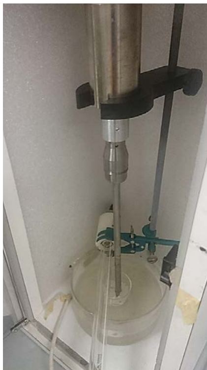
Figura 6.28 Fotografia del set-up impiegato nei test di degradazione fotocatalitica sfruttando il processo Sono-Photocatalytic-Fenton con sonicatore Probe
