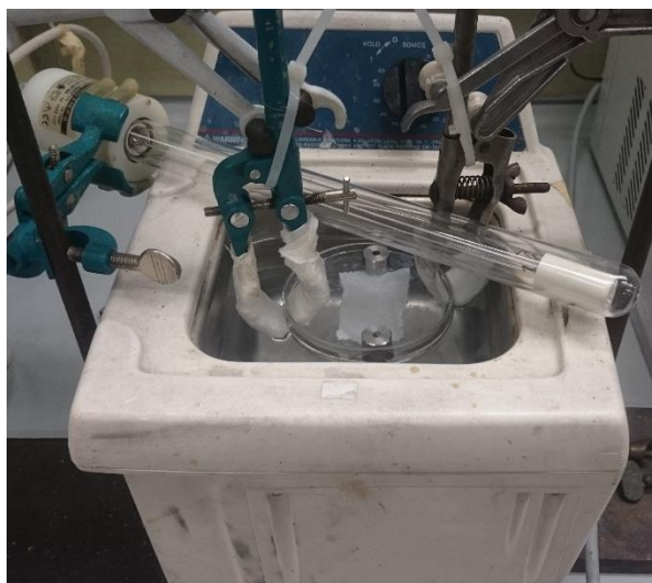
Figura 6.26 Fotografia del set-up impiegato nei test di degradazione fotocatalitica sfruttando il processo Sono-Photocatalytic-Fenton con bagno ad ultrasuoni
