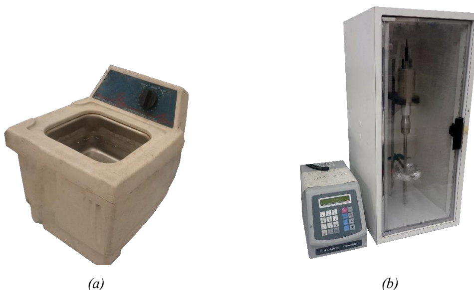
Figura 4.4 Due tecnologie di sonicatore. (a) Bagno ad ultrasuoni; (b) sonicatore a sonda
