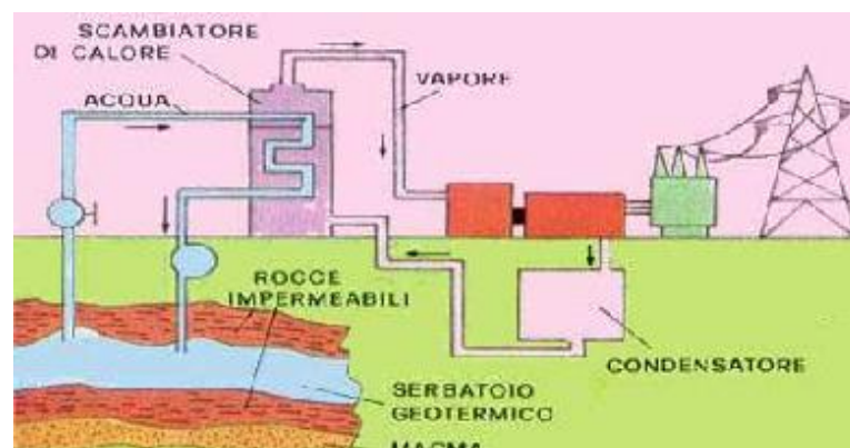
Figura 4.10 schema di funzionamento di un impianto geotermoelettrico.
