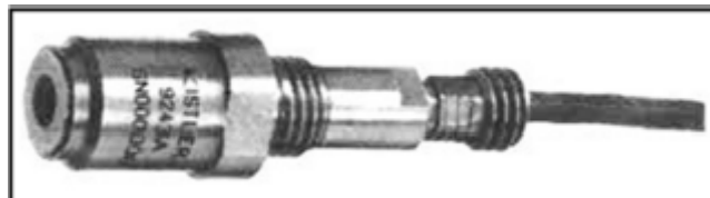
Figura 100: Cella di carico per la misura di F_n e F_t .
