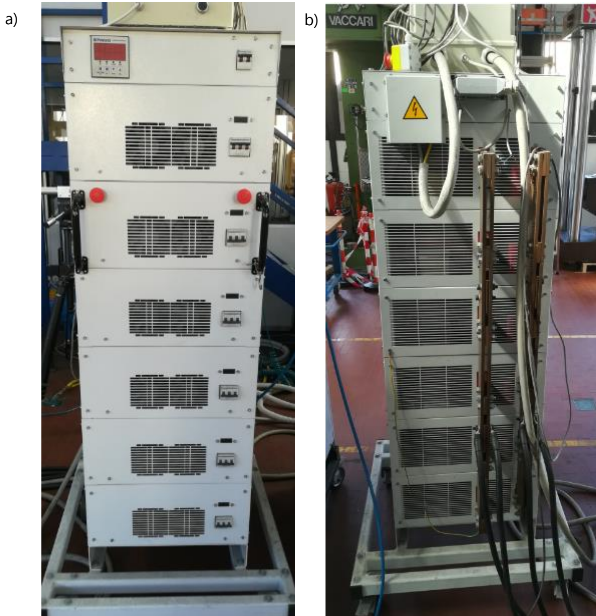
Figura 102: a) Vista frontale, b) Vista posteriore con sbarre di rame.
