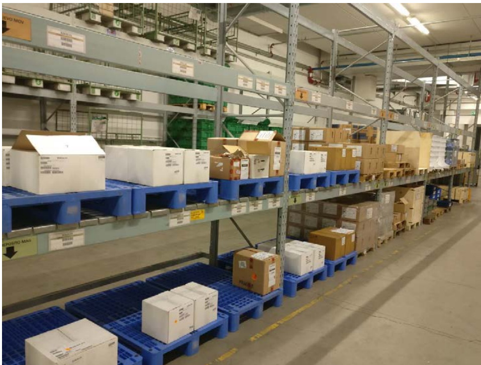
Figura 5.4 Scaffalatura magazzino 160 con logica FIFO
