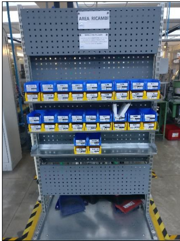
Figura 4.25 Area ricambi centralizzata per le linee di assemblaggio
