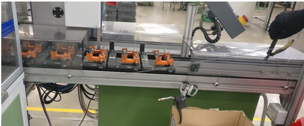
Figura 4.12 Posizionamento di una pinza nel luogo effettivo di utilizzo. Si è utilizzata una catena per tenerla in quel posto
