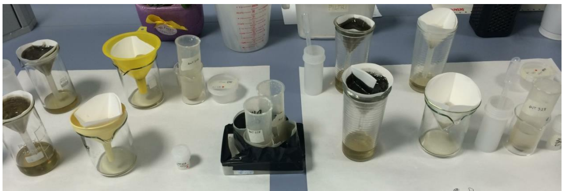
Fig. 4.9: processo di separazione per densità.
