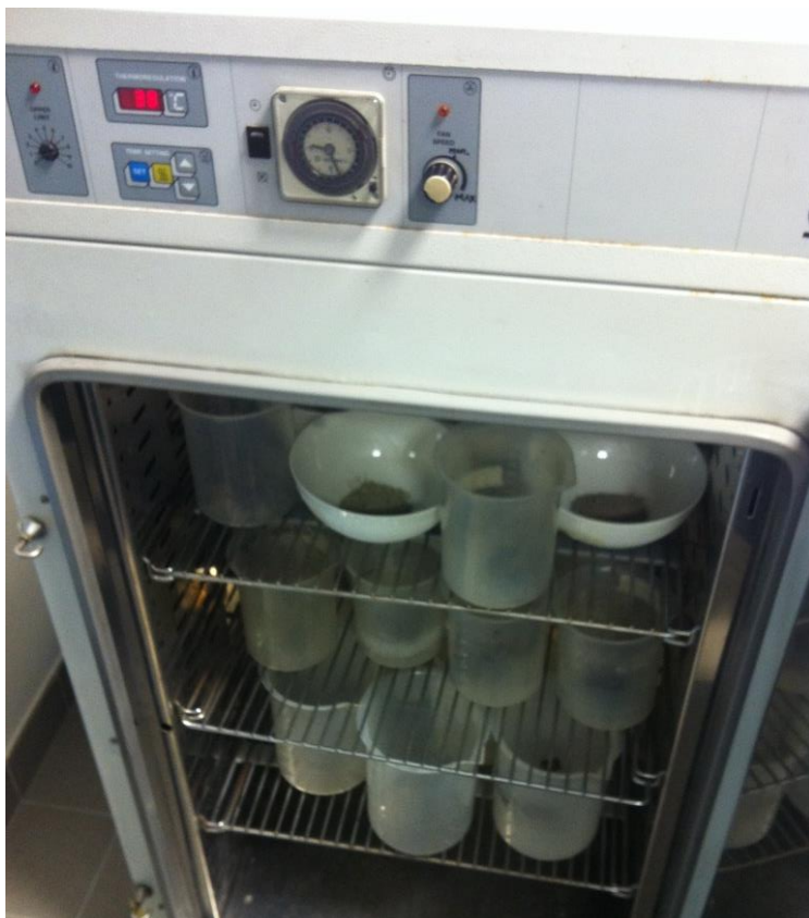
Fig. 4.7: campioni posizionati in forno ad essiccare
