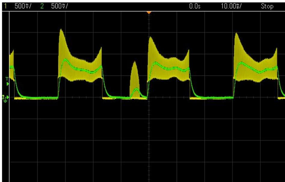
Fig. 6.6 - Segnale tachimetro a bassa velocità, amplificato e filtrato
