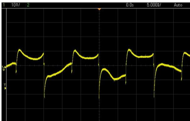
Fig. 6.2 - Uscita tachimetro ad alta velocità
