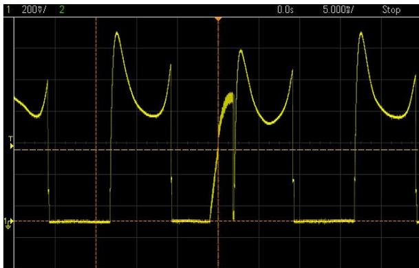
Fig. 6.4 - Segnale tachimetro amplificato ad alta velocità
