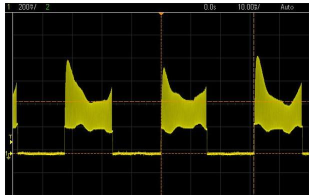
Fig. 6.5 - Segnale tachimetro amplificato a bassa velocità
