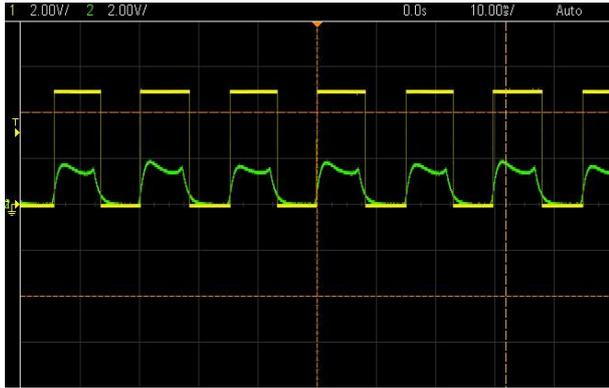
Fig. 6.7 - Ingresso e uscita del comparatore ad alta velocità
