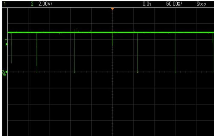
Fig. 6.10 - Segnale uscita circuito adattamento
