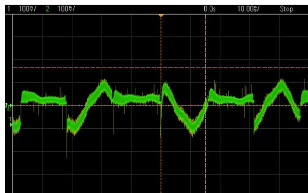
Fig. 6.3 - Uscita tachimetro a bassa velocità
