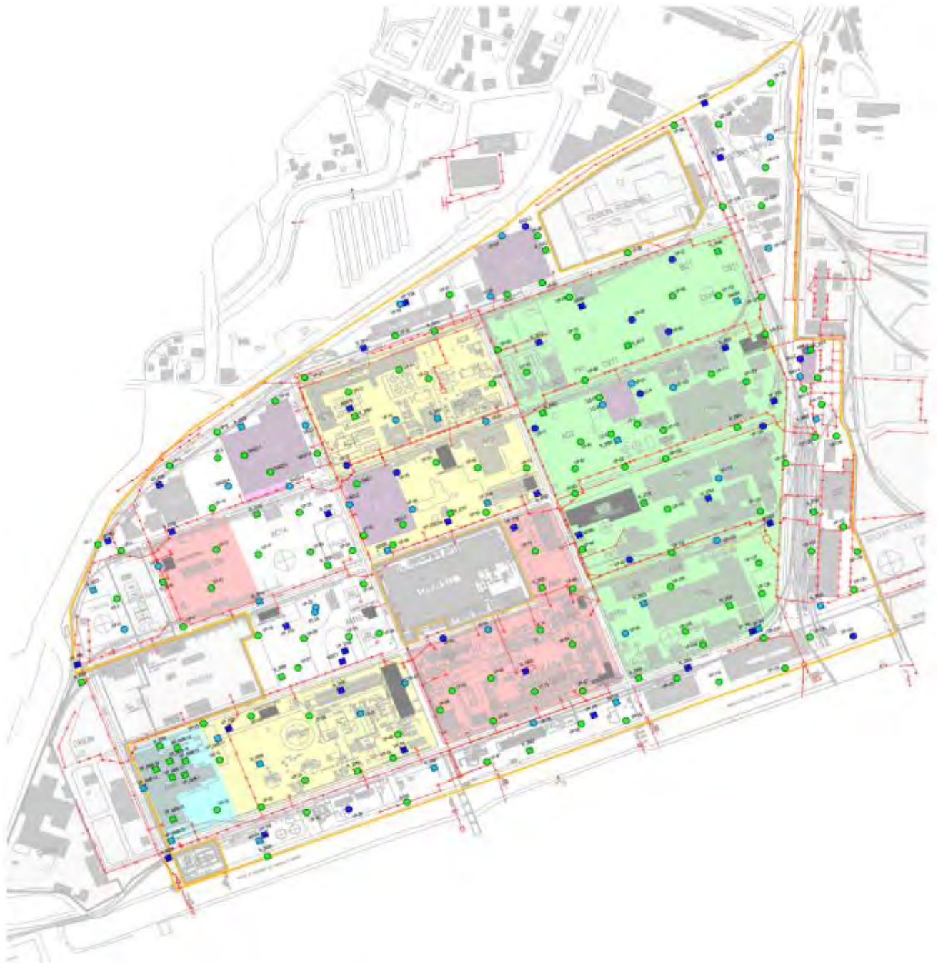
Fig. 4.3.1 _Planimetria ubicazioni indagini“ particular. ■ AM8 ■ old buildings ■ Chlorine line ■ Acetate line ■ inorganic line. Source: Risultati caratterizzazione integrativa (Set. 2005) Syndial.
