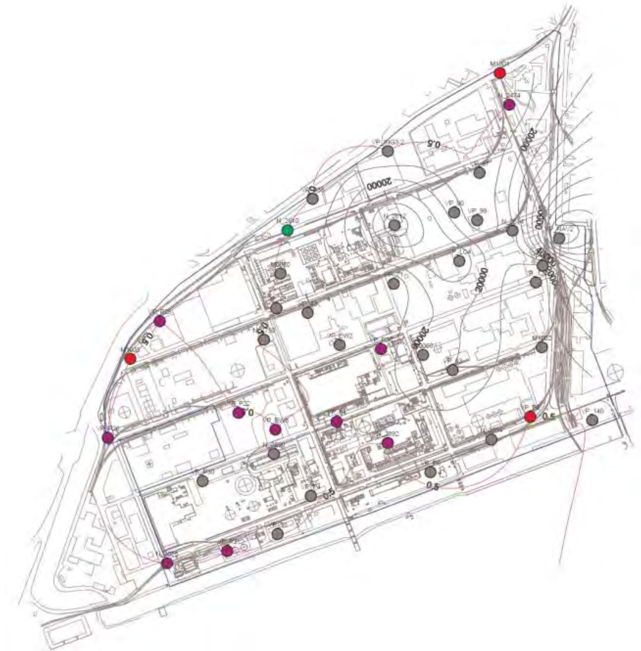
Fig. 4.4.6.1 _Distribuzione della contaminazione nelle abcque di prima falda; VCM““ particular. Concentrations ● < CLA, ● CLA-2CLA, ● 2CLA-10CLA, ● >10CLA. Source: Risultati caratterizzazione integrativa (Set. 2005) Syndial.
